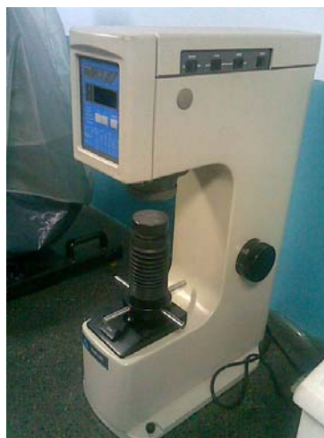
Figura N° 3.5. Durómetro digital marca MACROMET modelo 5100T
