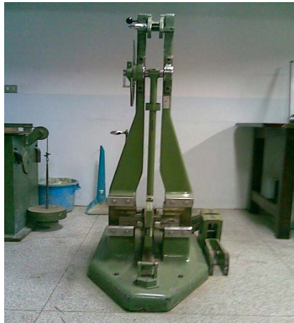
Figura N° 3.6. Máquina para realizar el ensayo de Impacto Charpy, marca FRANK
