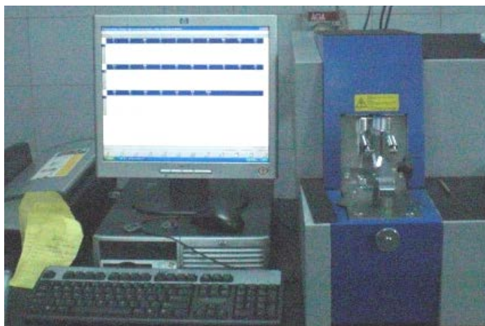
Figura 3.6 Espectrómetro de emisión óptica marca Avantis y su computador.
