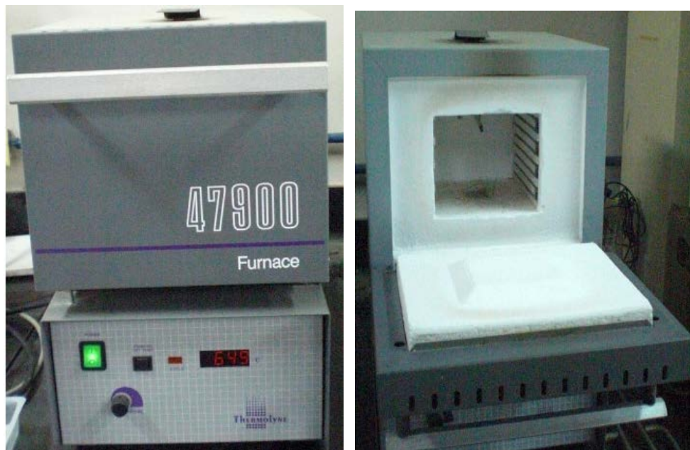
Figura 3.11 Horno eléctrico marca THERMOLINE.
