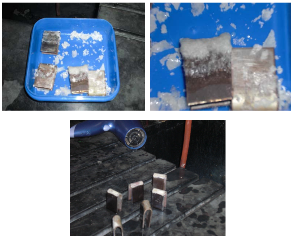
Figura 4.4 Limpieza de los cristales formados en las muestras para ser sometido a pruebas preliminares.
