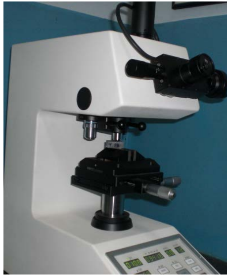
Figura 3.13 Microdurometro marca BUEHLER.
