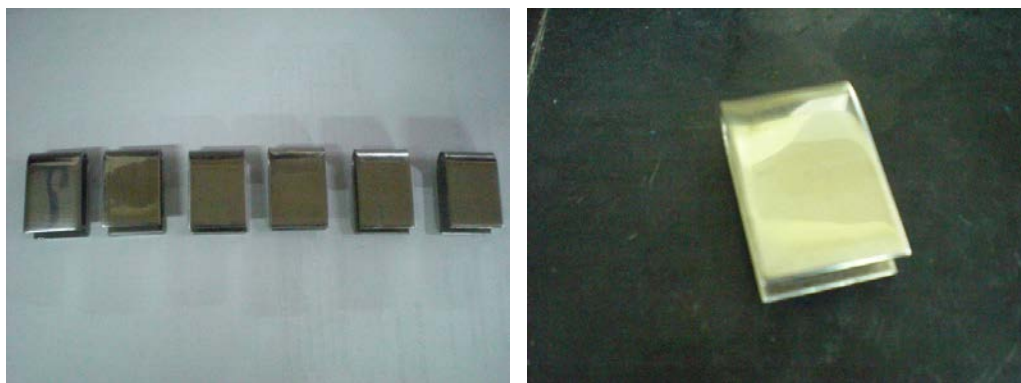
Figura 3.20 Muestra iniciales, preparadas metalograficamente para ser ensayadas con ácido corrosivo.
