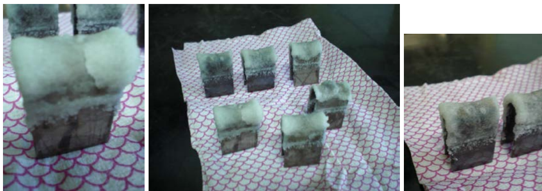
Figura 4.3 Muestras sacadas de los envases después del ataque químico, aparición de los cristales de oxalato.
