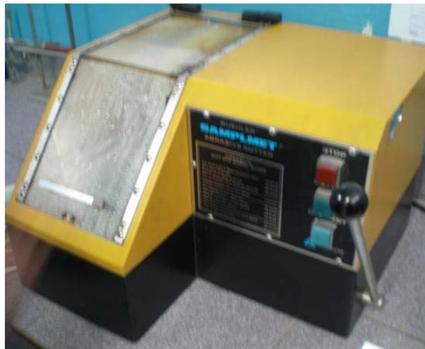
Figura 3.15 Esmeril de disco marca BUEHLER con refrigerante.
