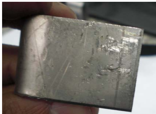
Figura 3.19 Muestra inicial mecanizadas, antes de la preparación metalográfica.
