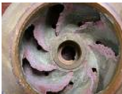
Figura 2.12 Corrosión por erosión en la industria. (TPI. S.A.)
