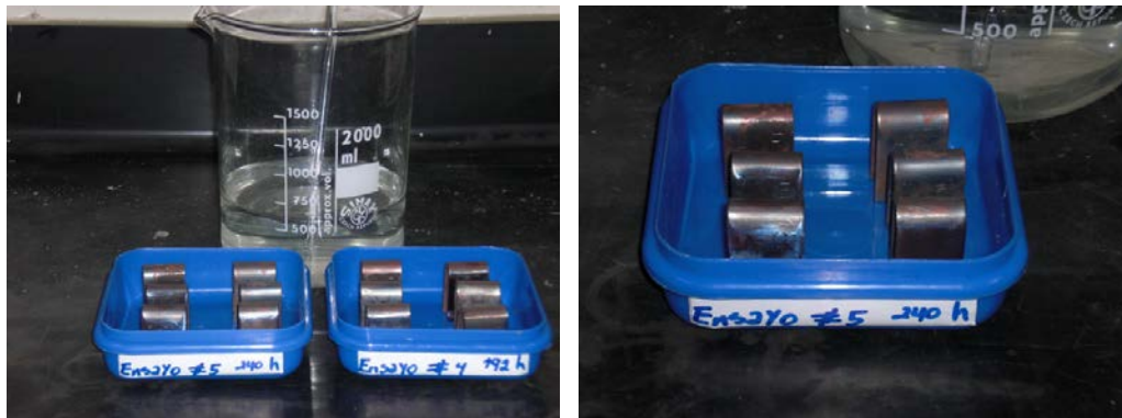
Figura 3.25 Muestras posicionadas en los correspondientes envases previamente identificados, preparados para el contacto con el ácido oxálico.
