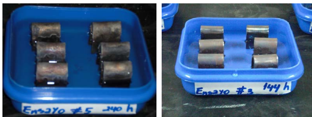
Figura 4.1 Muestras en contacto con ácido oxálico.
