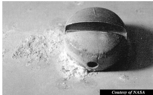
Figura 2.7 Corrosión localizada en aberturas en la industria. (TPI. S.A.)
