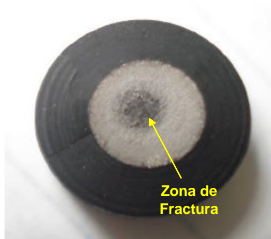
Figura 4.19. Macrofotografía de la Superficie de fractura del acero AISI 1018 en condición de Temple. ( S_f = 450 MPa, N = 4.100 ciclos).
