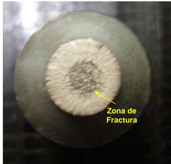
Figura 4.22. Macrofotografía de la Superficie de fractura del acero AISI 1018 en condición de Normalizado. ( S_f = 450 MPa, N = 10.700 ciclos).
