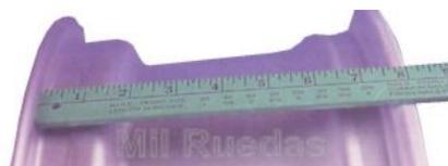
**Figura N° 2.8: Ejemplo de medición del ancho de cama**
