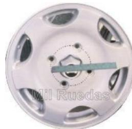
**Figura N° 2.9: Ejemplo de medición de la separación entre barrenos**
