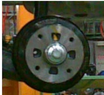
**Figura N° 2.11:** Maza de un vehículo con frenos tipo tambor con orificios para la fijación de los pernos que sujetarán el rín. Fuente: El Masri S. y Sánchez O.
