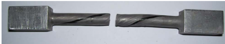
Figura N° 4.41. Condición de la probeta N° 3 una vez finalizado el ensayo de torsión.
