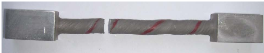
Figura N° 4.31. Condición de la probeta N° 3 una vez finalizado el ensayo de torsión.
