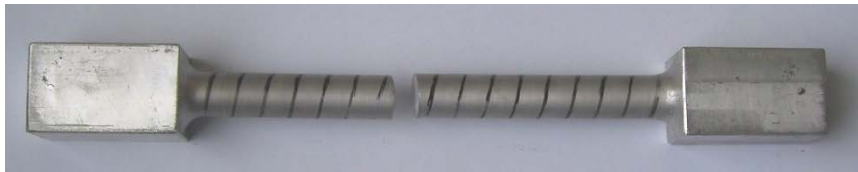
Figura N° 4.23. Condición de la probeta N° 4 una vez finalizado el ensayo de torsión.
