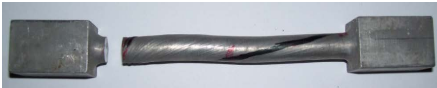
Figura N° 4.43. Condición de la probeta N° 4 una vez finalizado el ensayo de torsión.
