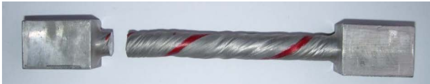
Figura N° 4.33. Condición de la probeta N° 4 una vez finalizado el ensayo de torsión.
