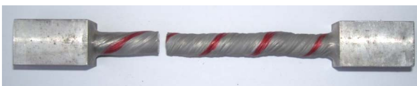
Figura N° 4.35. Condición de la probeta N° 5 una vez finalizado el ensayo de torsión.
