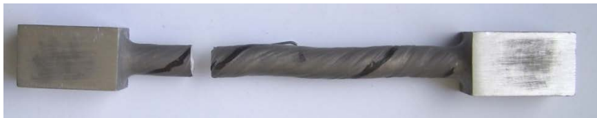
Figura N° 4.37. Condición de la probeta N° 1 una vez finalizado el ensayo de torsión.
