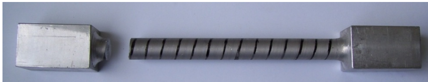
Figura N° 4.21. Condición de la probeta N° 3 una vez finalizado el ensayo de torsión.
