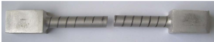
Figura N° 4.25. Condición de la probeta N° 5 una vez finalizado el ensayo de torsión.
