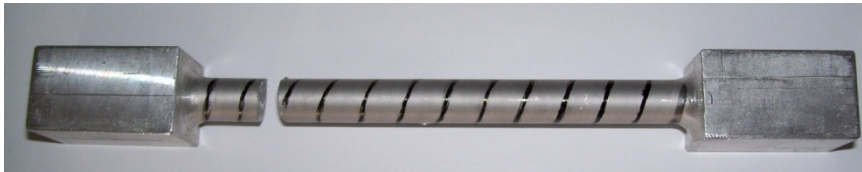
Figura N° 4.17. Condición de la probeta N° 1 una vez finalizado el ensayo de torsión.
