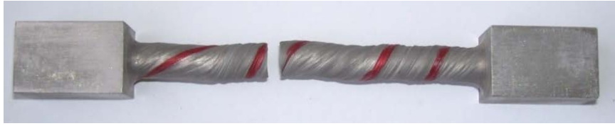
Figura N° 4.27. Condición de la probeta N° 1 una vez finalizado el ensayo de torsión.
