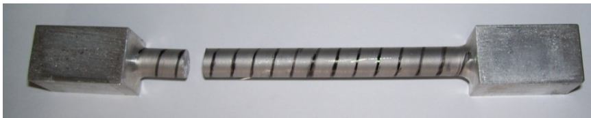
Figura N° 4.19. Condición de la probeta N° 2 una vez finalizado el ensayo de torsión.
