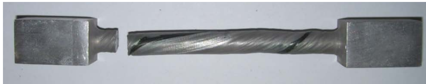
Figura N° 4.39. Condición de la probeta N° 2 una vez finalizado el ensayo de torsión.
