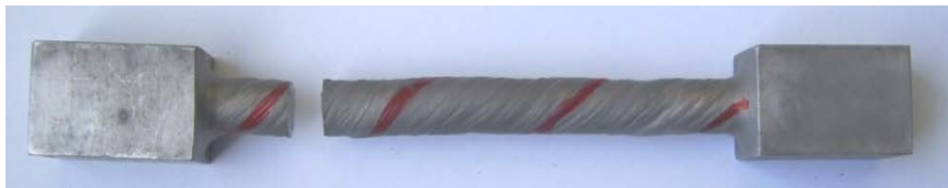
Figura N° 4.29. Condición de la probeta N° 2 una vez finalizado el ensayo de torsión.
