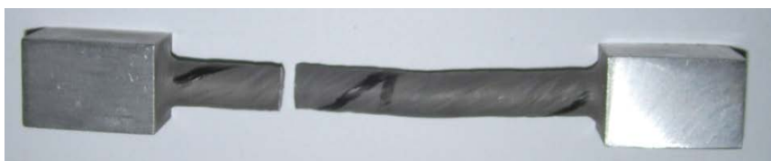
Figura N° 4.45. Condición de la probeta N° 5 una vez finalizado el ensayo de torsión.
