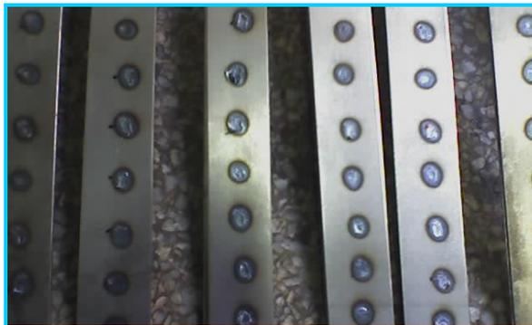
Figura 4.14. Puntos de soldadura en láminas de desgaste.
