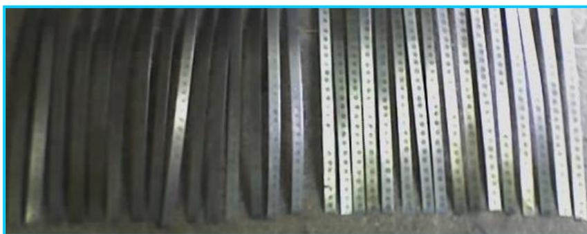
Figura 4.8. Láminas de desgaste del electrodo.
