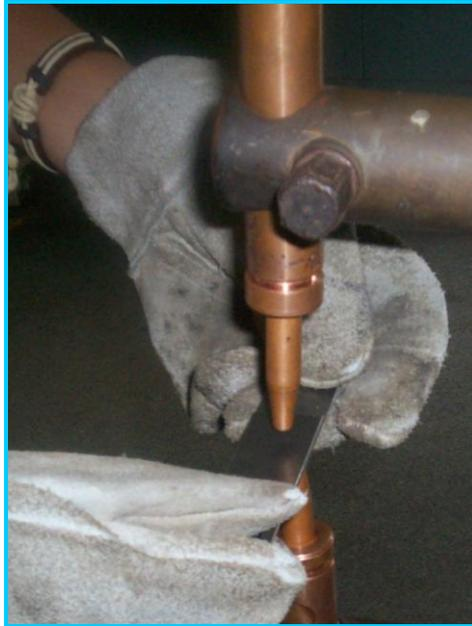
Figura 4.13. Proceso de soldadura para el ensayo destructivo Peel
