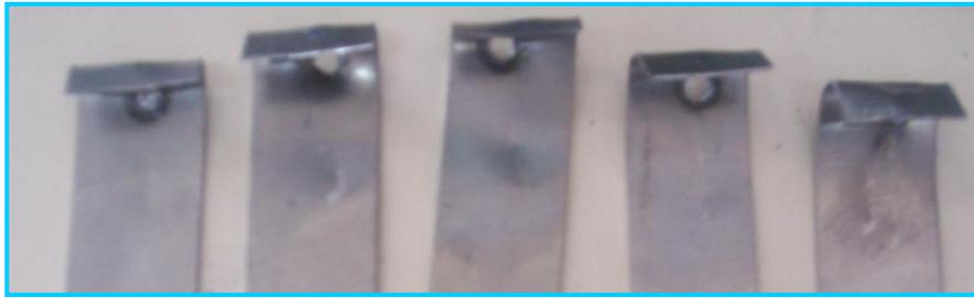
Figura 4.4. Muestras del ensayo Peel después de ser separadas (Falla por desgarramiento)
