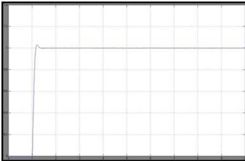
Figura 30. Respuesta temporal para la velocidad con la implementación del controlador QFT y parámetros máximos de planta.
