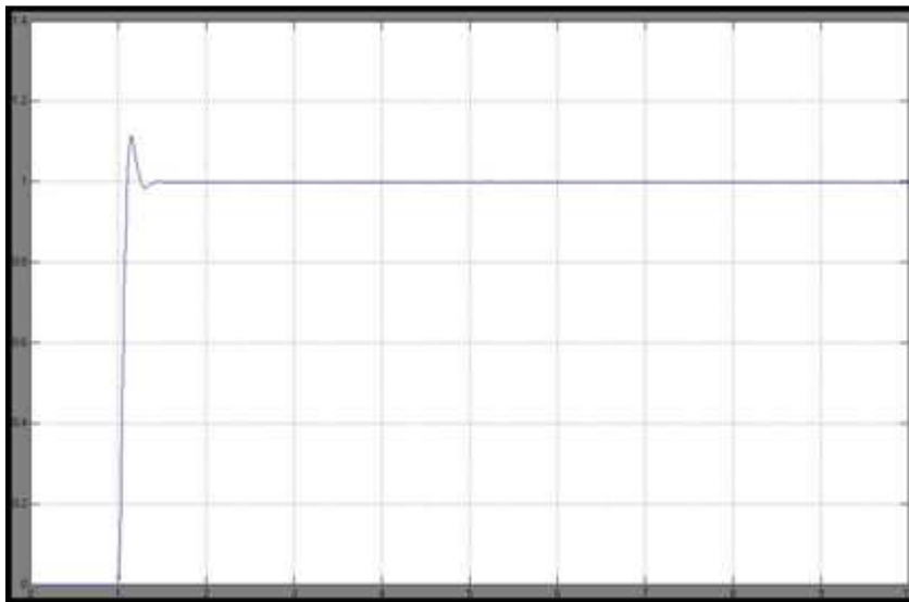
Figura 26. Respuesta temporal para la velocidad con la implementación del controlador QFT y parámetros nominales de planta.
