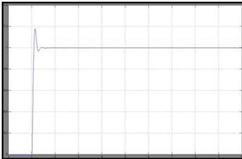
Figura 28. Respuesta temporal para la velocidad con la implementación del controlador QFT y parámetros mínimos de planta.
