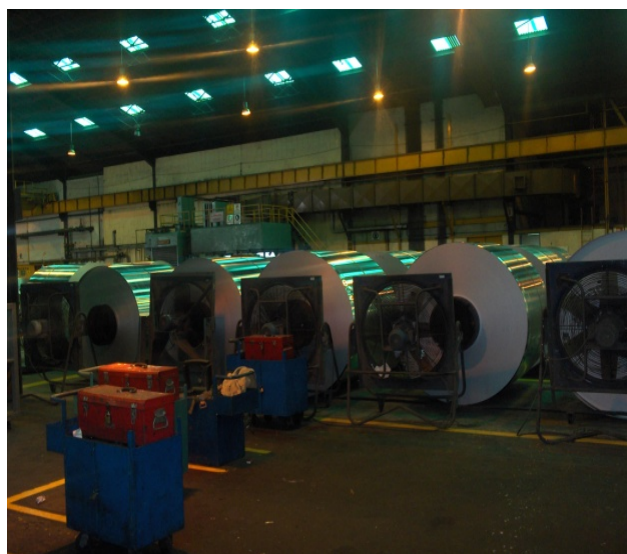
Figura 4.2.- Sistema de enfriamiento actual (modalidad 1)
