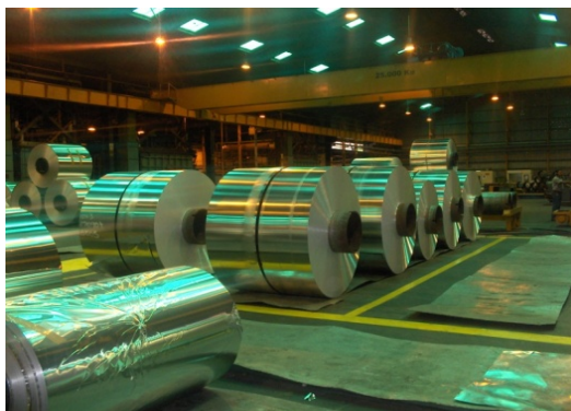
Figura 4.4- Zona de enfriamiento actual
