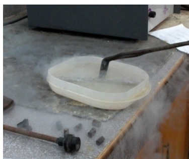
Figura 4.14 y 4.15.- Probetas enfriadas con nitrógeno líquido
