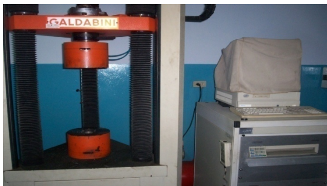
Figuras 4.16.- Equipo universal de ensayo de materiales GALDABINI
