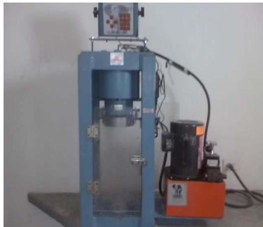
Figura. 4.12. Máquina de compresión Forney. (Fuente propia).
