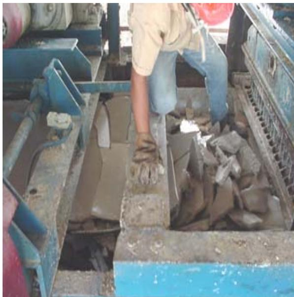
Figura 1.3. Sulfato de aluminio atascado (Fuente: Propia)
