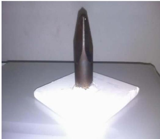
Fig. 4.11 Diente utilizado en el ensayo a compresión. (Fuente propia).
