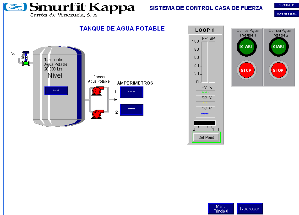
Figura 4. 16. Ventana Tanque de Agua Potable.
