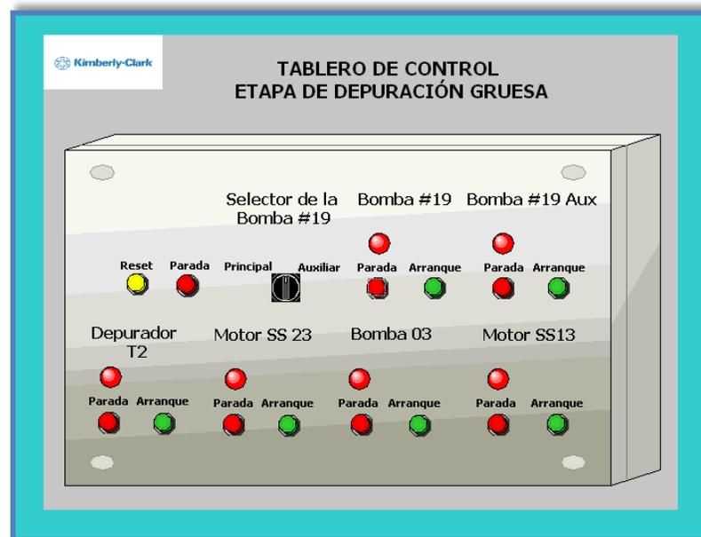
**Figura 4.5. Ventana del tablero de control de la etapa de depuración gruesa.**
