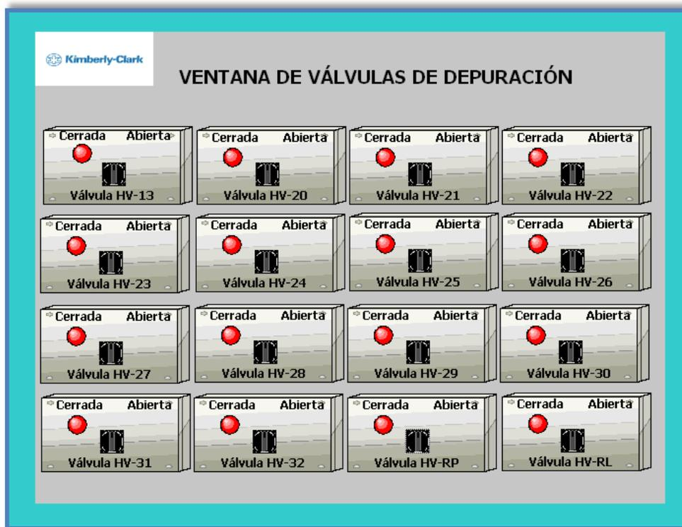
**Figura 4.20. Ventana de válvulas de depuración.
