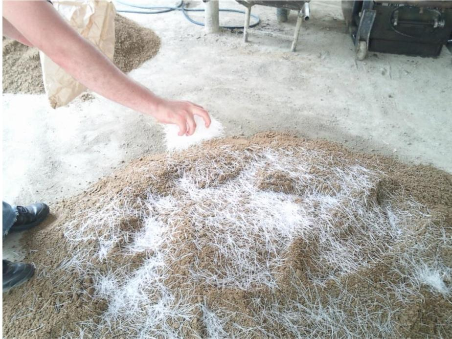
**Figura 8.** Incorporación de la fibra de polipropileno.
