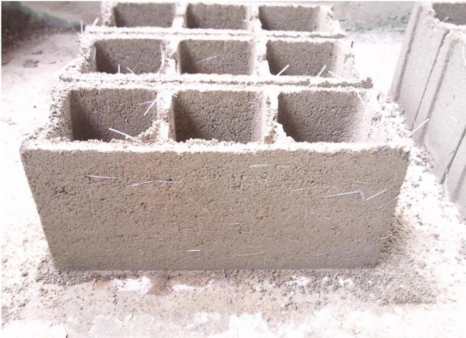
**Figura 14.** Bloques listo para el curado.
