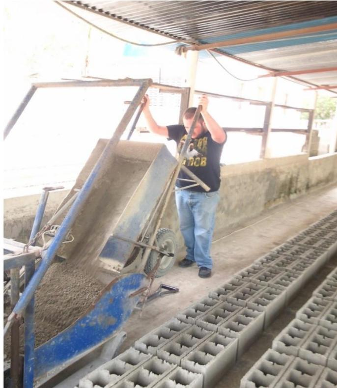
**Figura 12.** Mezcla colocada en la maquina ponedora.
