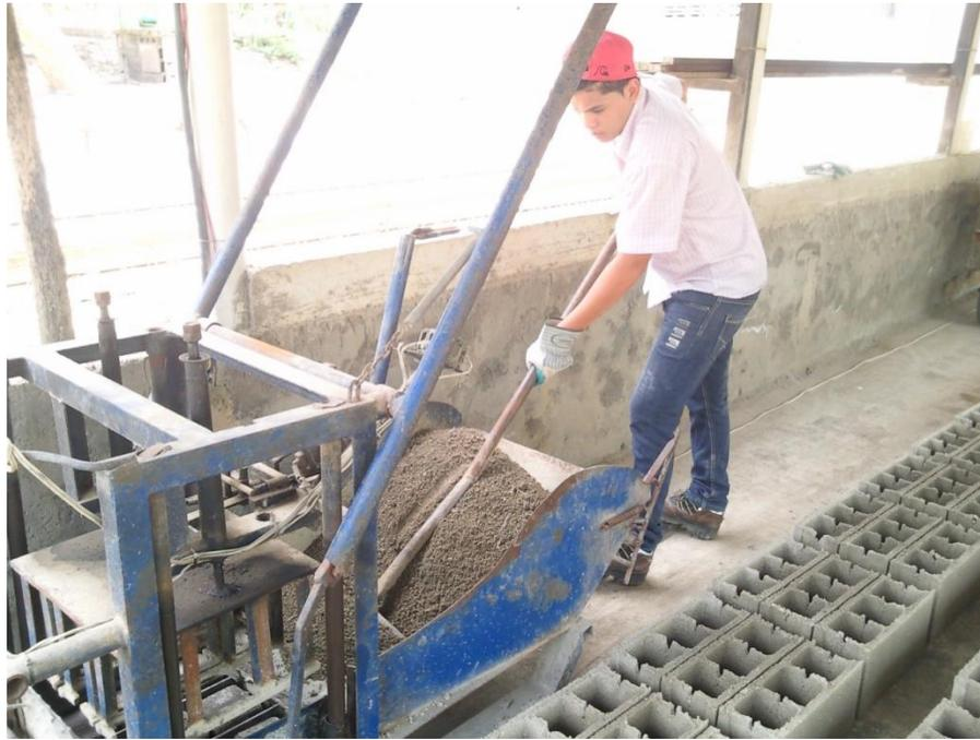
**Figura 13.** Repartición de la mezcla en el molde.
