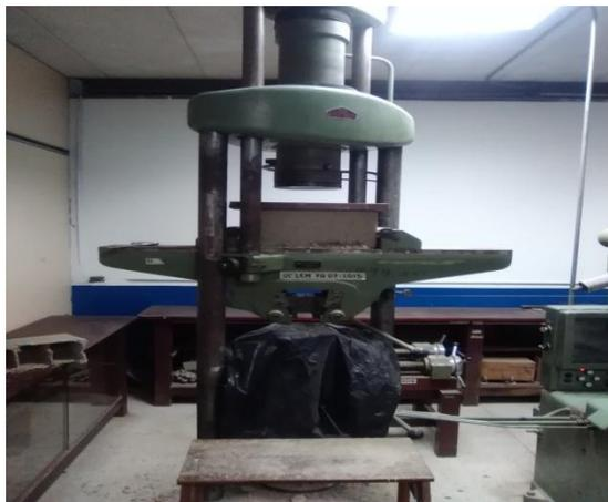
Ensayo de la resistencia a compresión.
