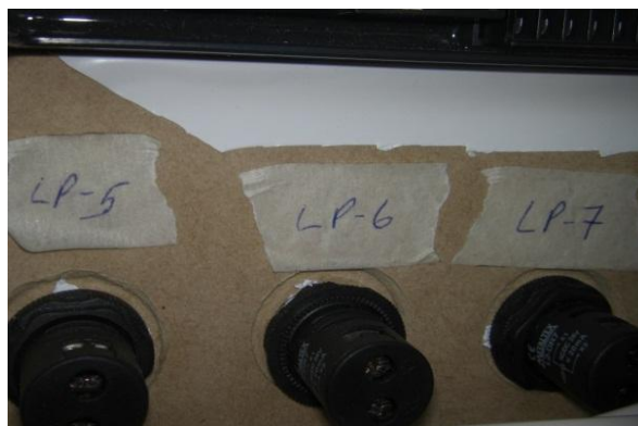
Figura 4.24 Orificios realizados con dos mechas sierra copa
