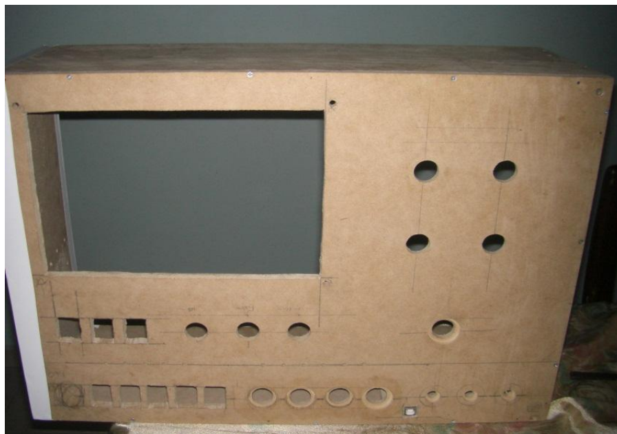
Figura 4.25 Orificios a medida en la madera del panel frontal
