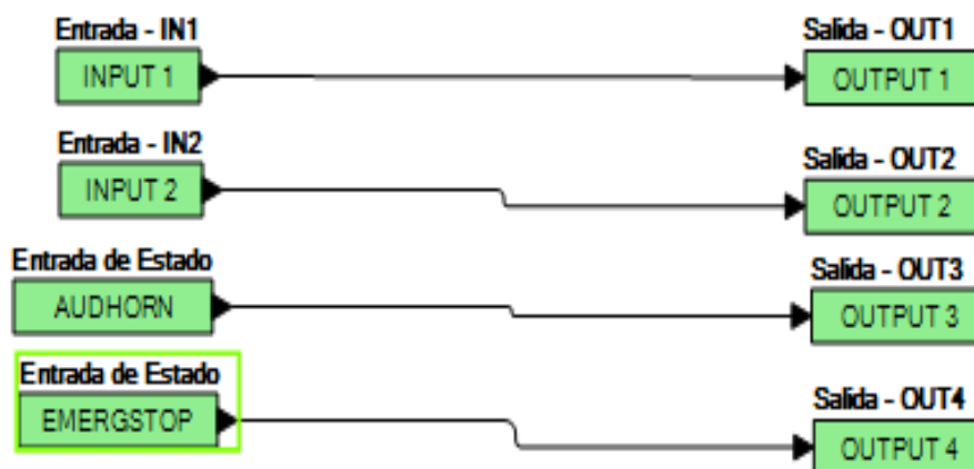
Figura 4.12 Accionamiento de salidas digitales por tres formas distintas
