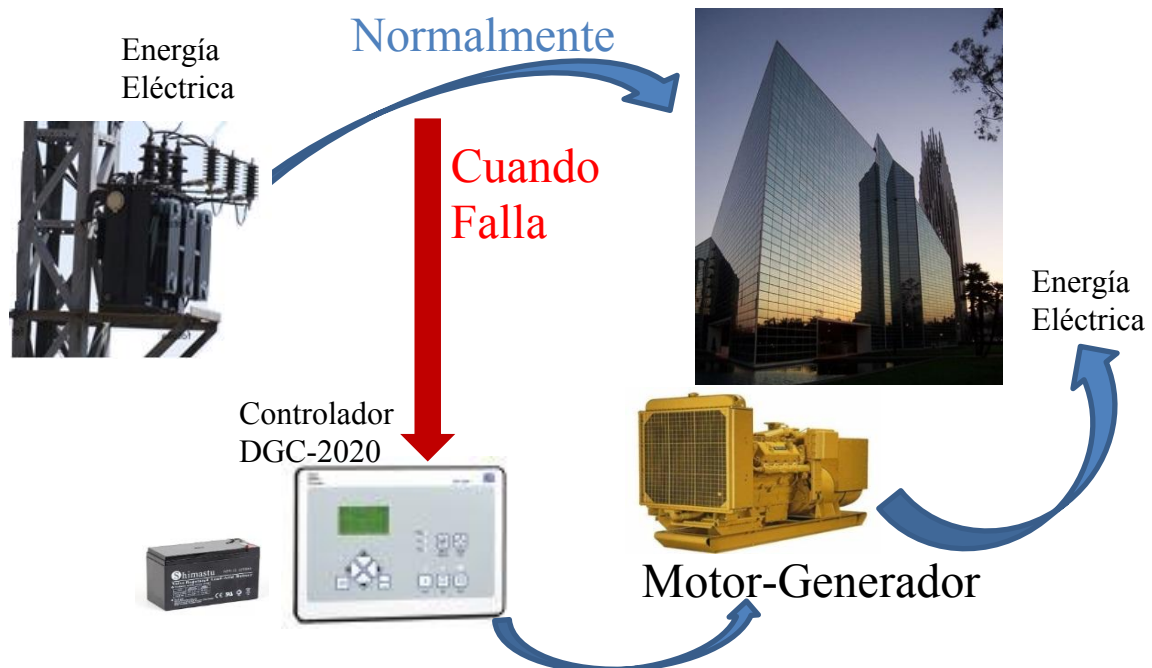
Figura 4.1 Reconexión de la energía eléctrica por motor-Generador, cuando ésta falla
