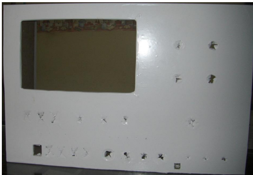
Figura 4.26 Colocación del papel autoadhesivo en la madera del panel frontal
