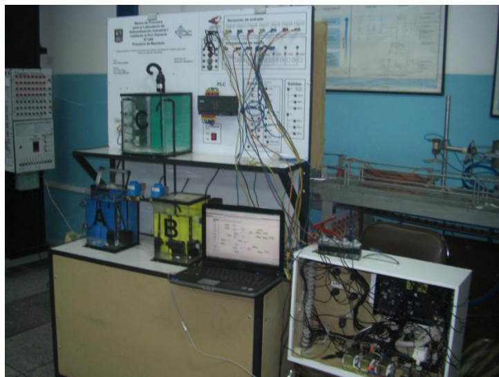
Figura 4.33 Interconexión de los dos bancos de procesos
