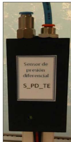
**Figura 4. 25 Aspecto externo del sensor MPX10DP.**
