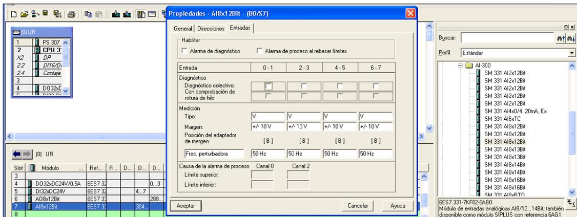
**Figura 5. 25 Propiedades del módulo de entradas AI8x12Bit.**
