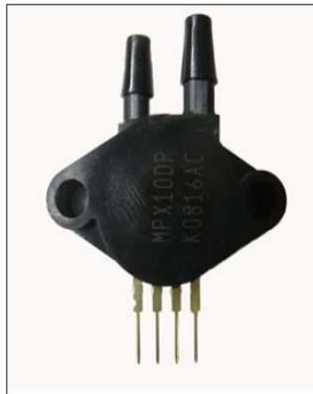
**Figura 4. 22 Sensor de presión diferencial MPX10DP.**
