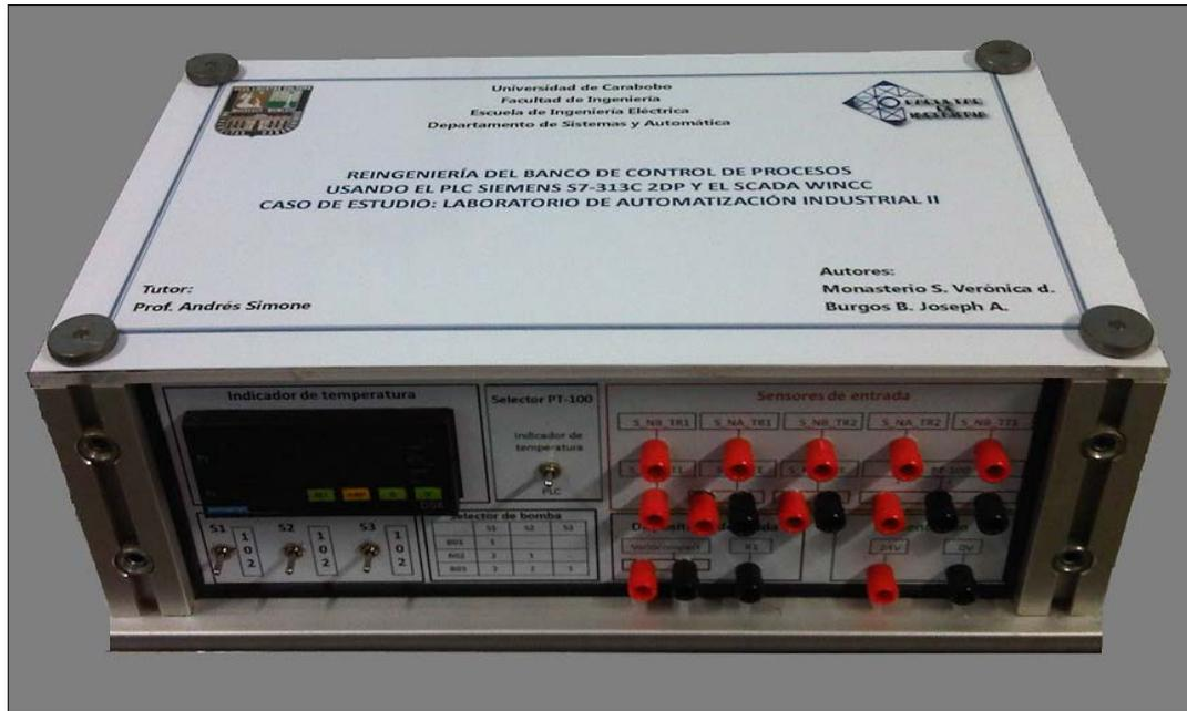
**Figura 4. 36 Acabado exterior de bornera de conexión**
