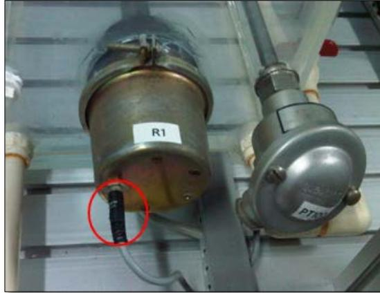
**Figura 4. 21 Reemplazo del cable de control del calefactor.**
