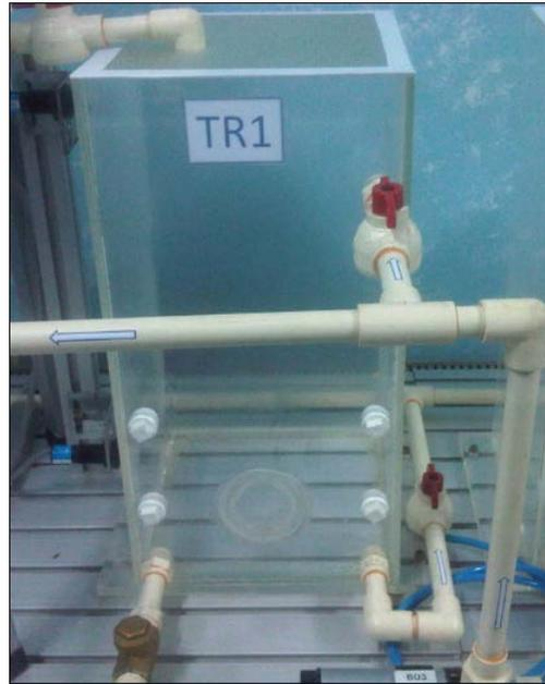
**Figura 4. 14** Purga de tanque TR1.
