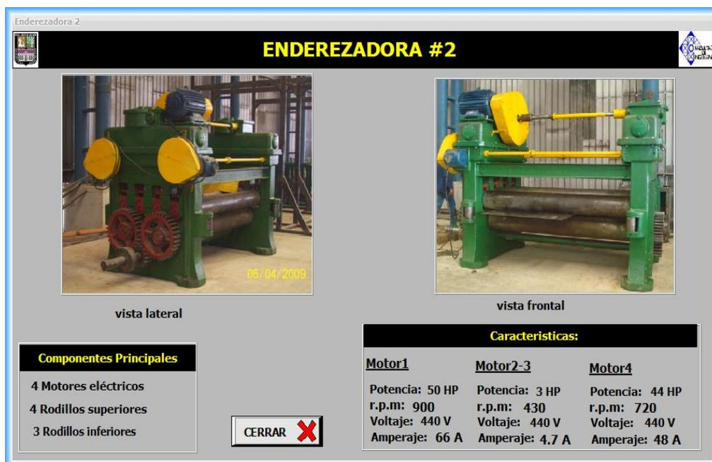
Figura. C.6 Enderezadora # 2
