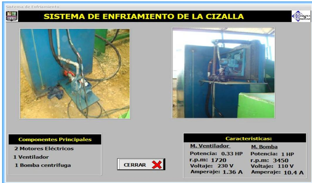
Figura. C.9 Sistema de enfriamiento de la cizalla
