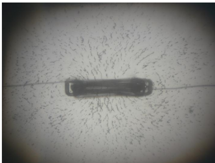
Figura 4.3. Resultado del Experimento #3. Orientacion de las líneas de campo magnético en una espira rectangular. (a) Vista de planta del experimento. (b) Proyección del experimento por medio de un retroproyector.
