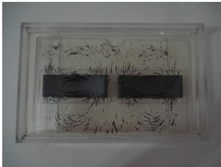
Figura 4.1 Resultados del experimento #1. Orientación de las líneas de fuerza en presencia de un imán permanente.
