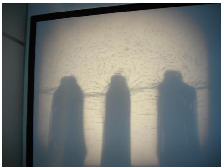
Figura 4.4. Resultado del Experimento #4. Líneas de campo magnético en espiras rectangulares conectada en paralelo. (a) Vista de planta del experimento. (b) Proyección del experimento por medio de un retroproyector.
