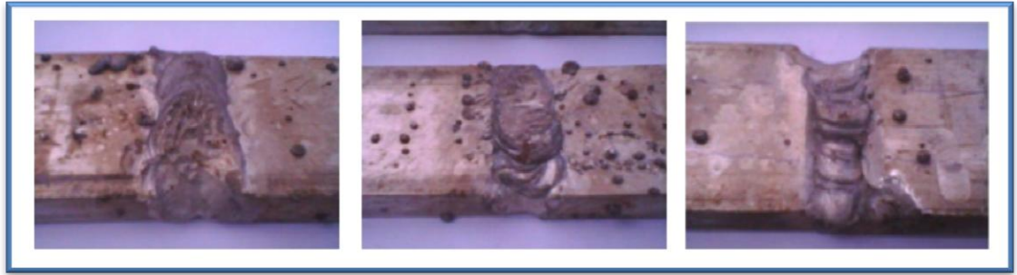
Fig.4.4. Probetas de 1, 2 y 3 pasadas de Aluminio 6063.
