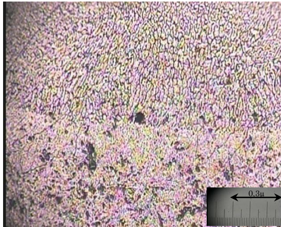
Zona de transición 200X, (0.3 \mu ) (MA parte superior – MB parte inferior)
