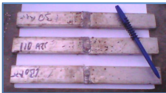
Fig.4.3. Probetas de aluminio 6063 soldadas de 1, 2 y 3 pasadas.
