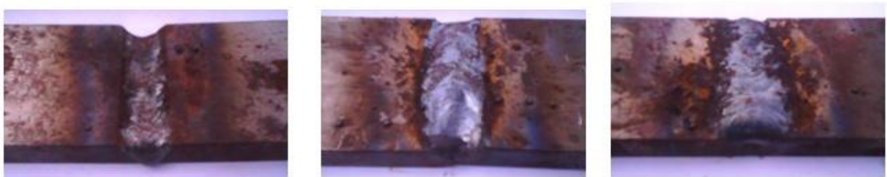
Fig.4.6. Probetas de 1, 2 y 3 pasadas de Acero 1010.
