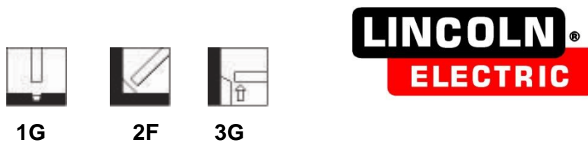
Fig. 3.12. Posiciones de Soldadura
