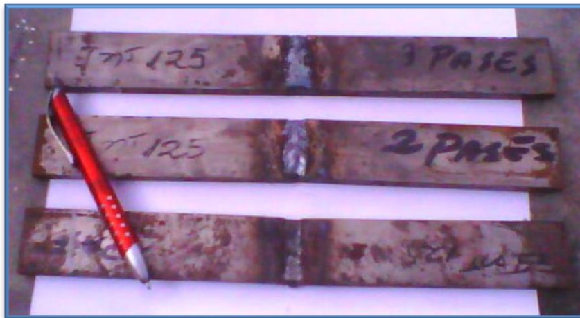
Fig.4.5. Probetas de acero AISI 1010 soldadas de 1, 2 y 3 pasadas.
