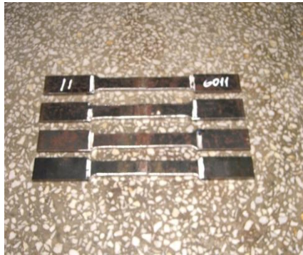
Figura 4.10 Probetas soldadas con electrodo celulósico E-6011 para ensayo de tracción
