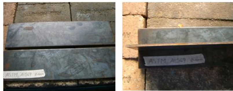
Figura 3.4 láminas de acero ASTM A-569, dimensiones 100 x 400 x 4 mm.
