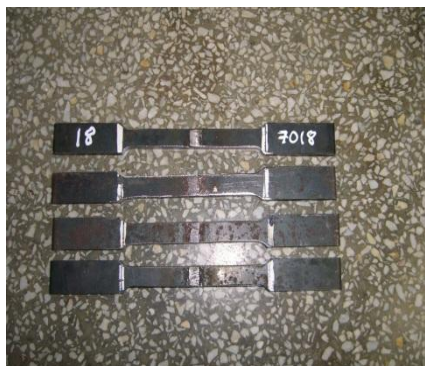
Figura 4.11 Probetas soldadas con electrodo bajo hidrogeno E-7018 para ensayo de tracción
