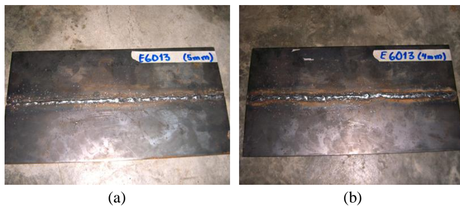
Figura 3.6 láminas de acero ASTM A-36(a) y ASTM A-569(b), soldadas con electrodos con revestimientos rutilico (E-6013).
