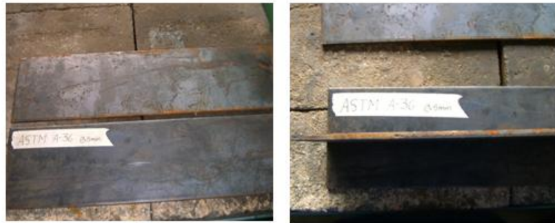
Figura 3.3 láminas de acero ASTM A-36, dimensiones 100 x 400 x 5 mm.
