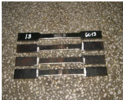
Figura 4.9 Probetas soldadas con electrodo rutilico E-6013 para ensayo de tracción
