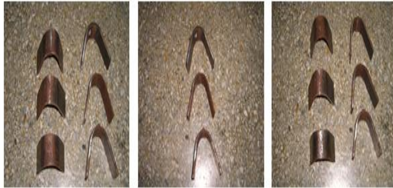
Figura 4.8 Probetas después del ensayo de doblado.
