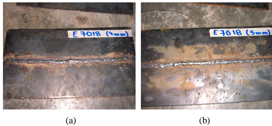
Figura 3.8 láminas de acero ASTM A-36(b) y ASTM A-569(a), soldadas con electrodos con revestimientos bajo hidrogeno (E-7018).
