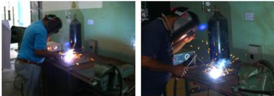
Figura 3.5 Realización de las soldaduras en las láminas.
