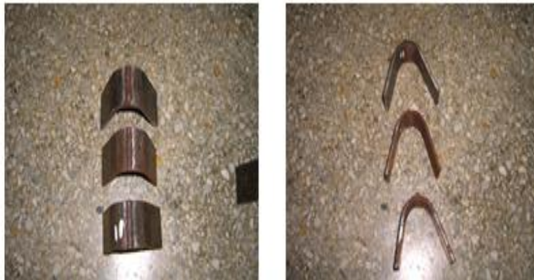
Figura 4.7 Probetas ensayadas, soldadas con electrodo celulósico E-6011
