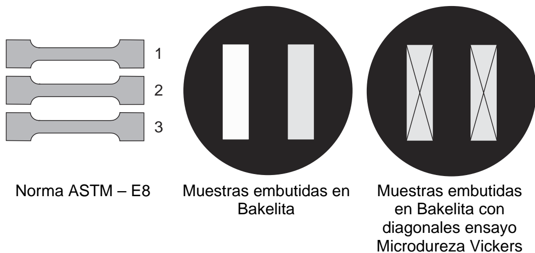
Fig. 15. Muestras norma ASTM-E8M; otras muestras.
