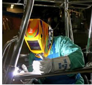
Fig. 11. Operario realizando el proceso de soldeo
