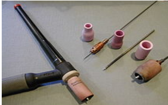
Fig. 9. Antorcha y Boquillas para realizar la soldadura TIG.
