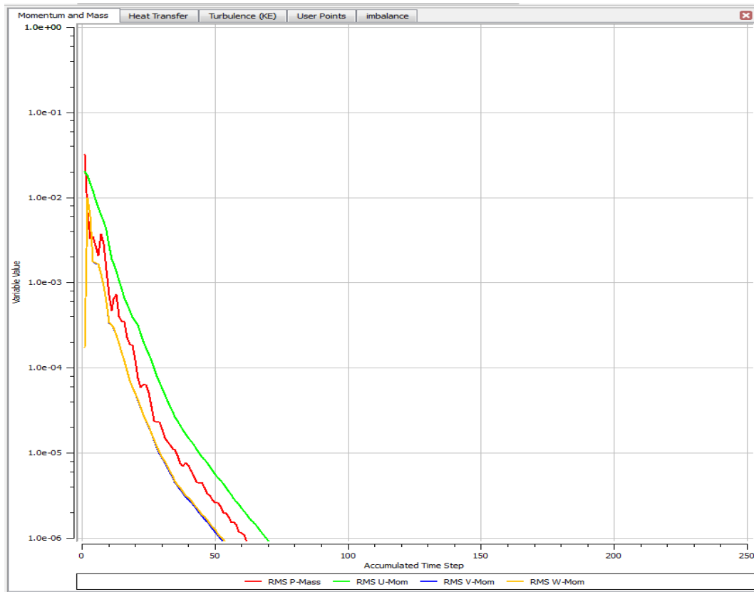
Figura 4.19 Convergencia de masa y momento para la simulación \alpha=9 y \epsilon=0,25 mm.
