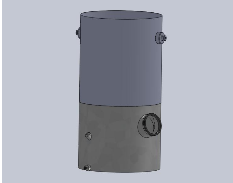
Anexo 15. Torre de absorción C-03, cuerpo de la torre.
