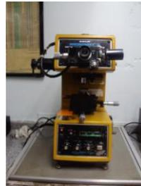
**Figura 3.9** Microscopio metalográfico.
