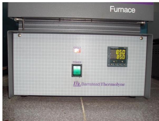
**Figura 3.1.-** Horno para recocido a 850 °C.
