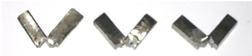
Figura 4.16 Probetas ensayadas del ensayo de Charpy para la caracterización del metal soldado.
