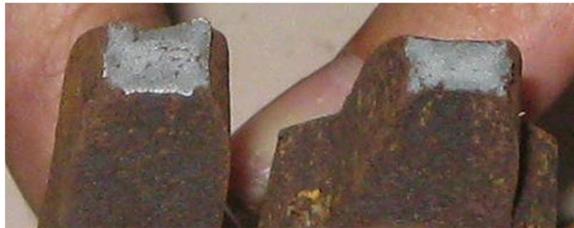
Figura 4.49 Fractura de las probetas de tracción ensayadas para un periodo de exposición de 48 hr.
