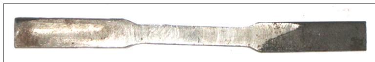
Figura 3.5. Muestra tipo Sheet para los ensayos de tracción
