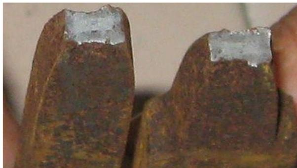
Figura 4.52 Fractura de las probetas de tracción ensayadas para un periodo de exposición de 96 hr.
