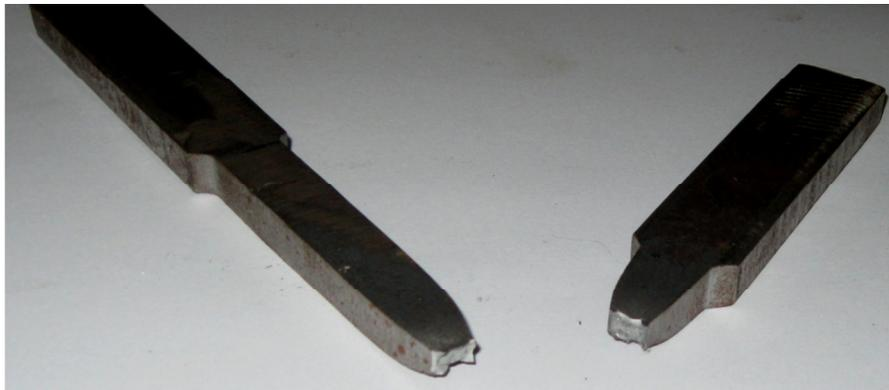
Figura 4.11. Tipo de fractura para las probetas de tracción ensayadas durante la caracterización del metal soldado.
