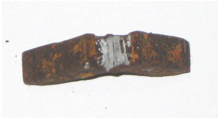
Tabla 4.67 Fractura de las probetas para el ensayo de impacto para un periodo de exposición de 48hr.
