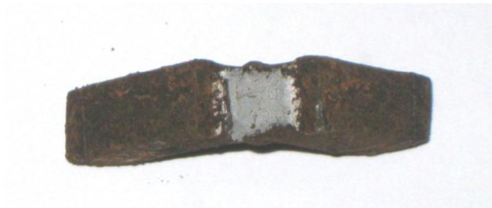
Tabla 4.73 Fractura de las probetas para el ensayo de impacto para un periodo de exposición de 196hr.
