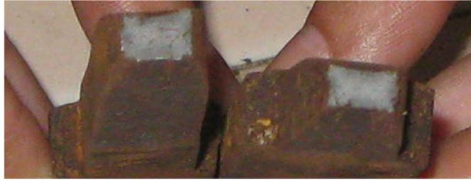
Figura 4.56 Fractura de las probetas de tracción ensayadas para un periodo de exposición de 196 hr.
