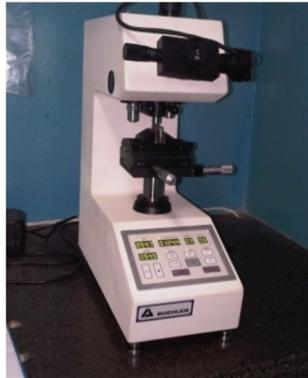
Figura 3.11. Microdurómetro
