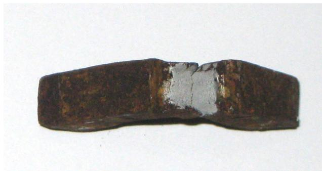
Tabla 4.70 Fractura de las probetas para el ensayo de impacto para un periodo de exposición de 96hr.
