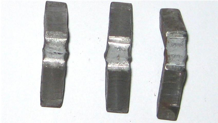
Figura 4.17 Fractura de las probetas ensayadas del ensayo de Charpy para la caracterización del metal soldado.
