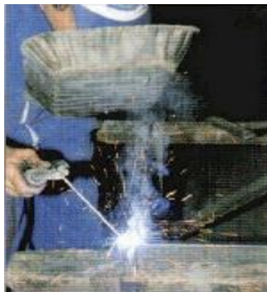
Figura 2.3: Proceso de soldadura por Arco eléctrico
