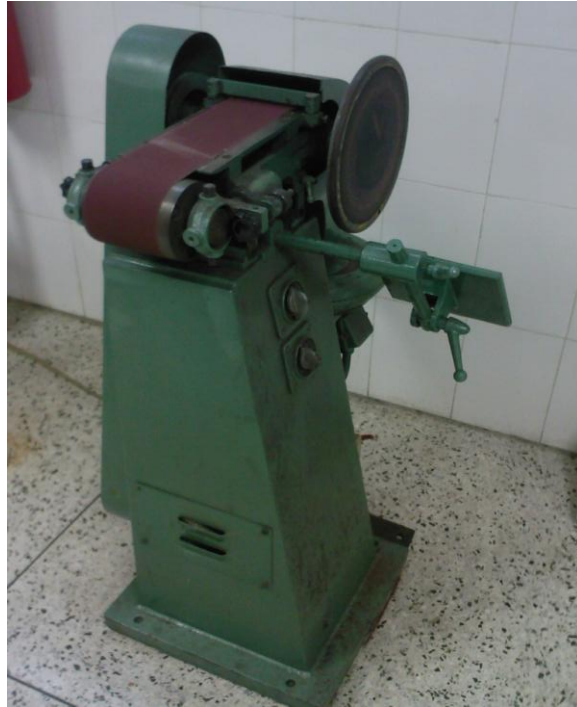
Figura N°3.12: Desbastadora de Cinta marca WILHELM SIMON KG
