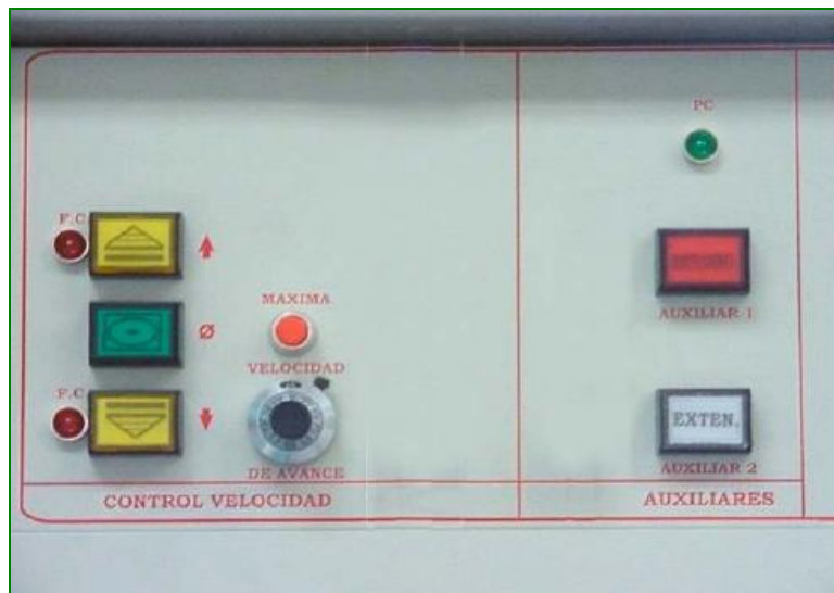
Figura N°3.10: Control de velocidad de la Máquina de ensayos universales HOYTOM, modelo DI-CP/V2
