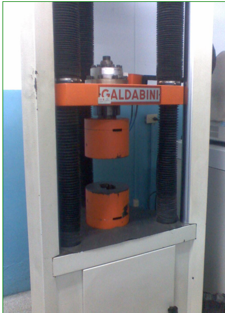
Figura N°3.11: Máquina de ensayos universales GALDABINI 20Ton.
