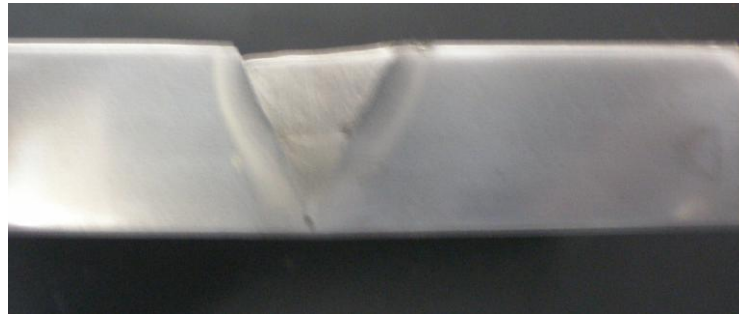
Figura 4.60 Probeta Acero AISI 1045 soldada bajo la condición de 160 Amp.
