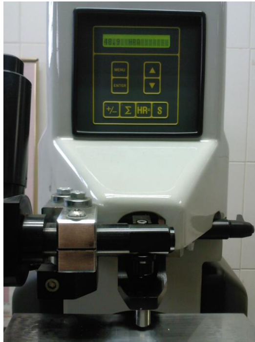
Figura N°3.15: Durómetro marca ZWICK/ ZHU empleado
