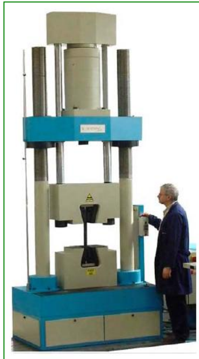
Figura N°3.9: Máquina de ensayos universales HOYTOM, modelo DI-CP/V2 100 Ton.
