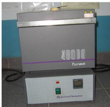
**Figura 3.7:** Horno eléctrico para tratamiento térmico de sensibilización
