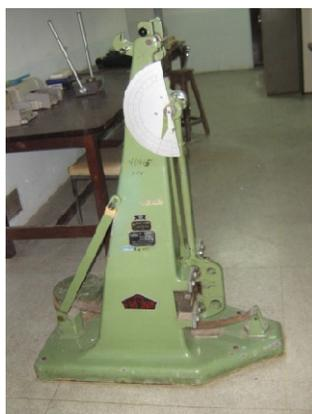
**Figura 3.10:** Máquina para Ensayo de Impacto Charpy
