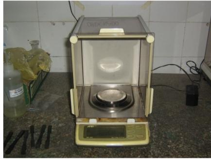
**Figura 3.8:** Balanza analítica para pesaje de probetas antes y después de la exposición al HNO<sub>3</sub>
