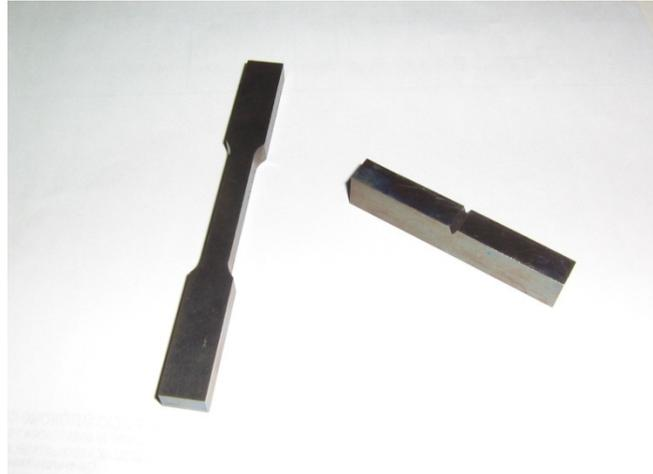
**Figura 4.1:** Probetas de Tracción e Impacto previas a la exposición al ácido y posteriores al tratamiento térmico de sensibilización
