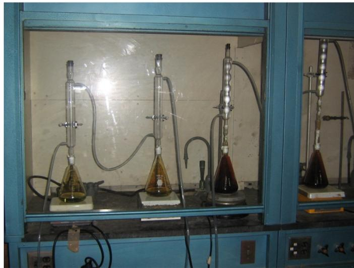
**Figura 3.21:** Montaje experimental para exposición al medio corrosivo. Conjunto de Matraces y Condensadores de reflujo ubicados sobre las planchas de calentamiento. Dos (2) frascos representan un período de exposición, conteniendo cada uno cinco (5) probetas de impacto y tres (3) probetas de tracción respectivamente
