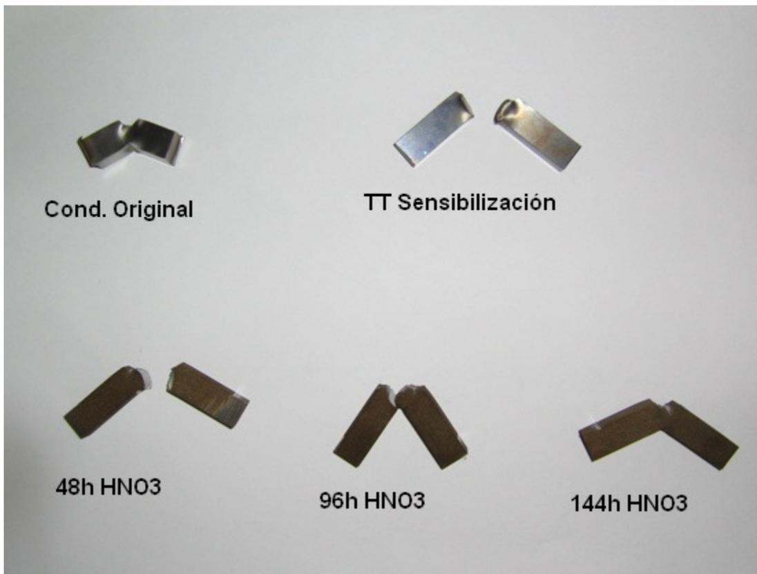
**Figura 4.14:** Probetas representativas de cada una de las condiciones ensayadas
