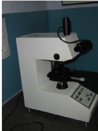
**Figura 3.17:** Microdurómetro Vickers
