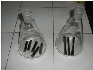
**Figura 3.20:** Probetas de Tracción e Impacto colocadas dentro de los Matraces Erlenmeyer
