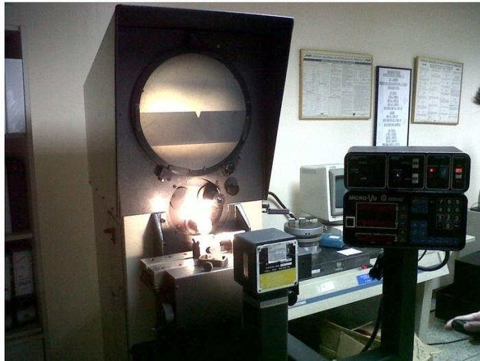
**Figura 3.6:** Perfilómetro para verificar dimensiones de Probetas Charpy
