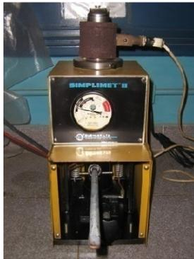
**Figura 3.13:** Prensa para embutir
