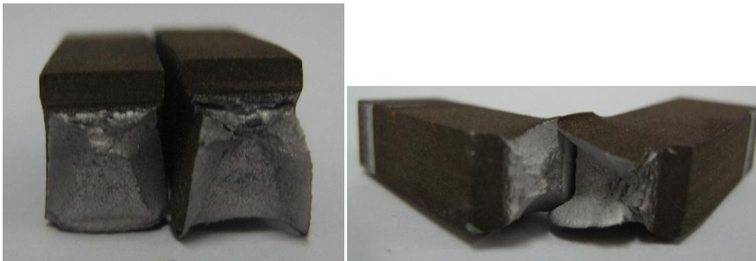
**Figura 4.17 (Izquierda):** Superficie de Fractura Macro de Probeta expuesta 48h en  $\text{HNO}_3$ .
