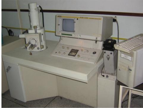
**Figura 3.16:** Microscopio Electrónico de Barrido
