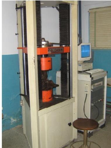
**Figura 3.11:** Máquina para Ensayo de Tracción
