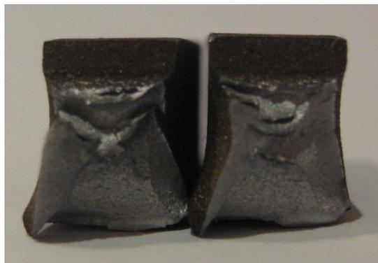
**Figura 4.19:** Superficie de Fractura Macro de Probeta expuesta 144h en  $\text{HNO}_3$
