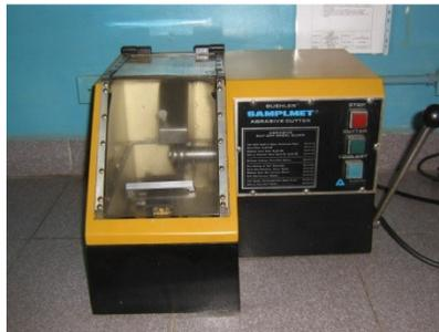
**Figura 3.12:** Cortadora Metalográfica
