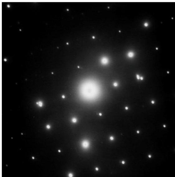
**(c)** Estructura cúbica fase clara ( $L = 1,2\mu\text{m}$ ). Condición de TT a 0,2 horas.
