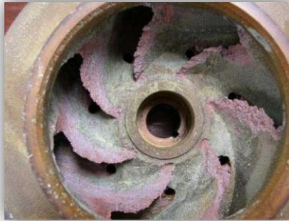
**Figura 2.15.** Corrosión por erosión.
