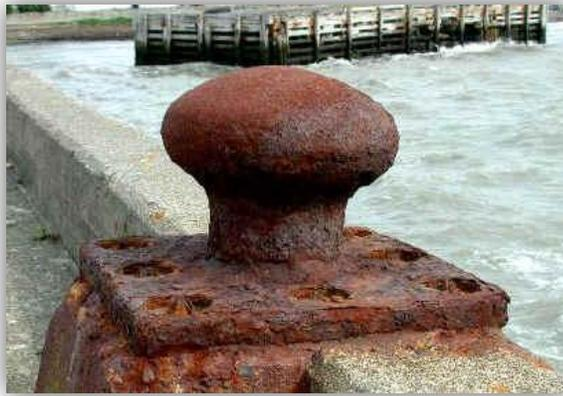
**Figura 2.10.** Corrosión Uniforme.
