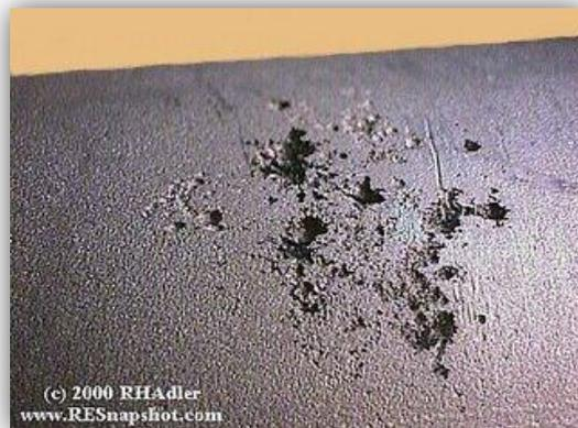
**Figura 2.11.** Corrosión por Picaduras.
