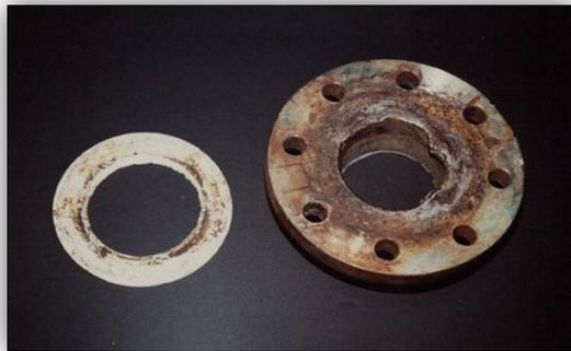
**Figura 2.12.** Corrosión por grietas.
