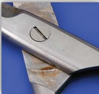
**Figura 2.13.** Corrosión por frotamiento.
