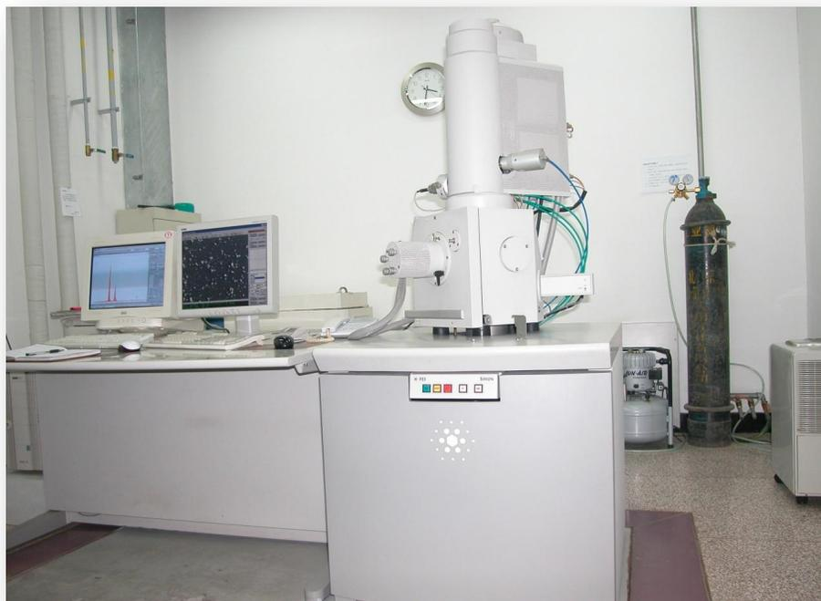
**Figura 3.14.** Microscopio Electrónico de barrido.
