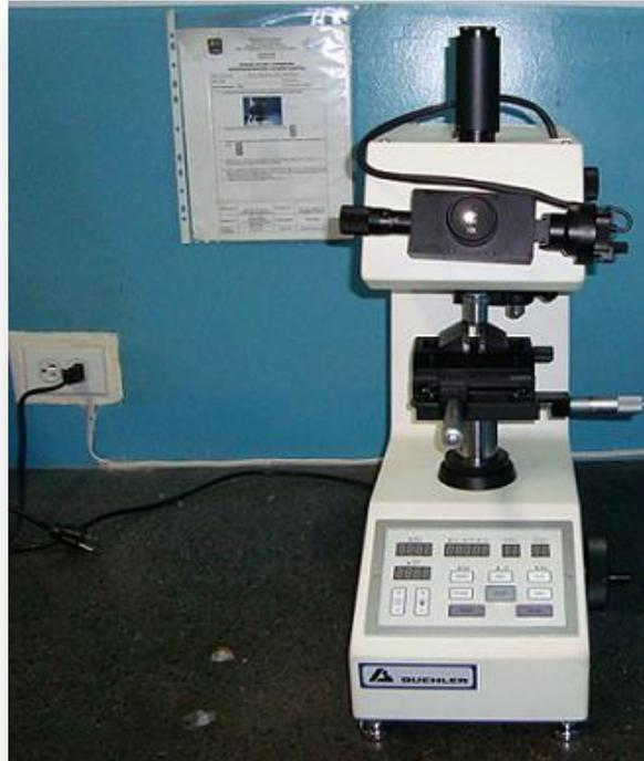
**Figura 3.13** Microdurómetro digital Vickers.
