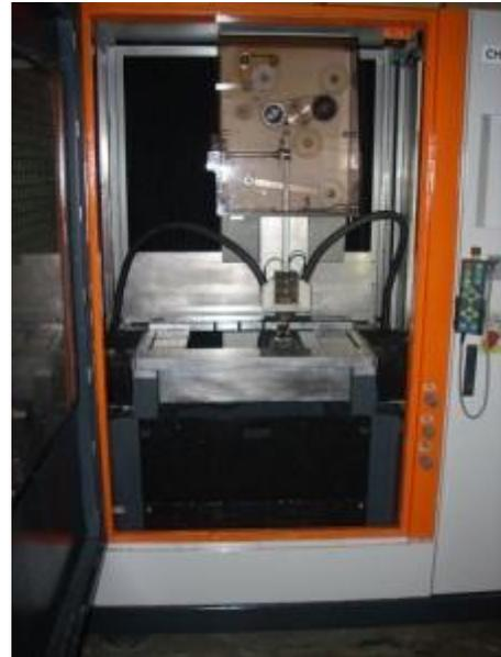
**Figura 3.3** Máquina de electroerosión de hilo (inyección de agua)
