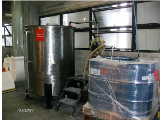
**Figura Nº 5. Dosificación del No- iónico en la etapa de post adición**
