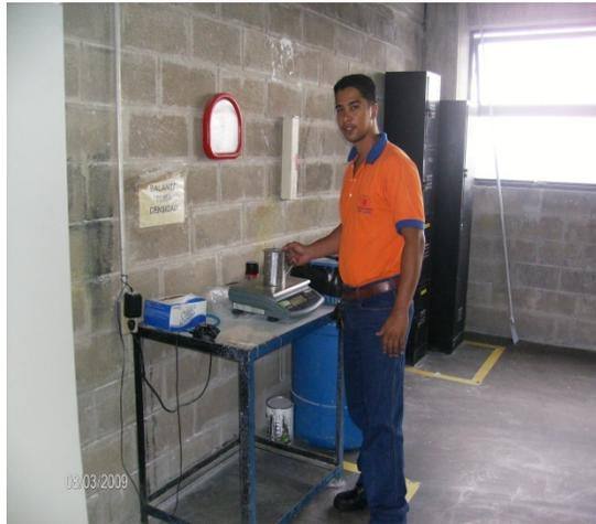
**Figura Nº 12. Toma de densidad aparente del detergente en la etapa de post adición.**
