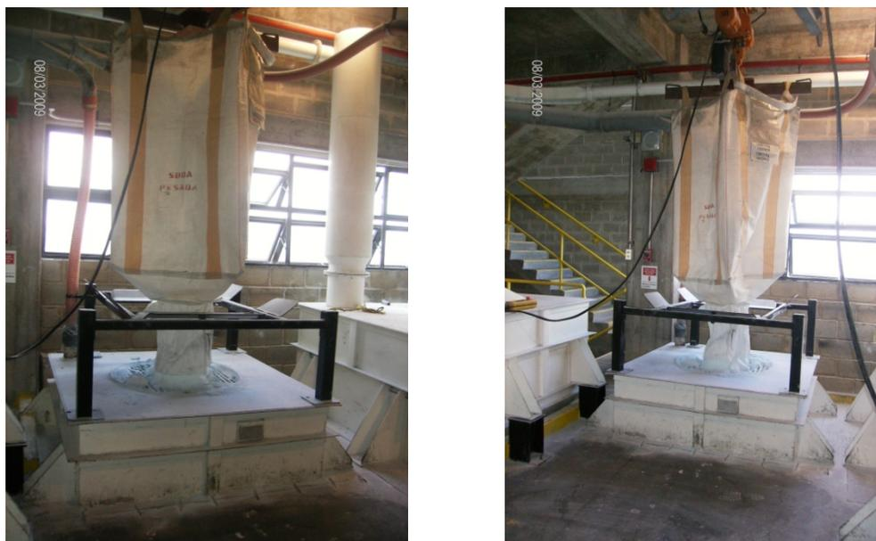
**Figura N° 7. Dosificación de Soda Ash**
