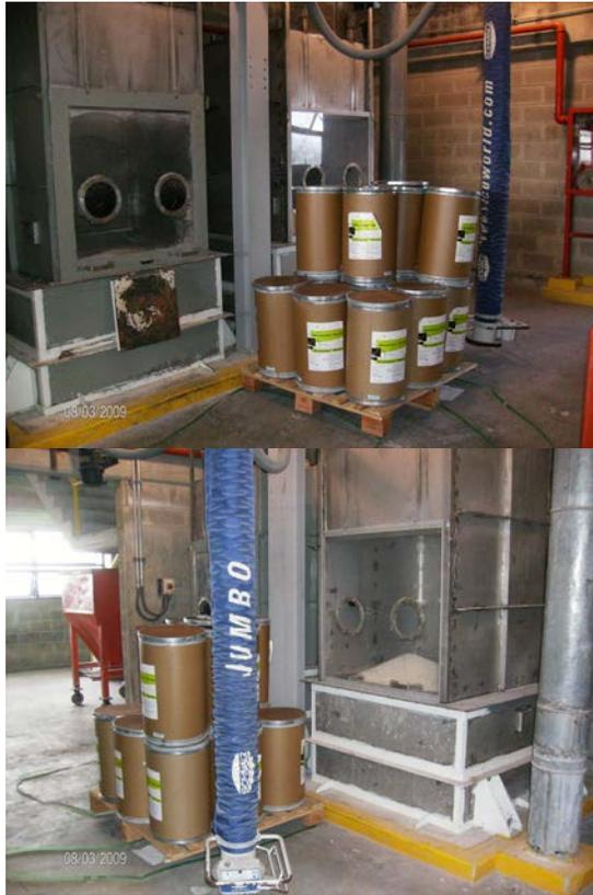
**Figura N° 3. Dosificación de enzimas en la etapa de post adición.**
