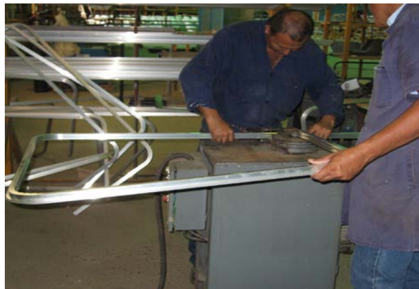
Figura N°9. Tambaleo del perfil en la maquina
