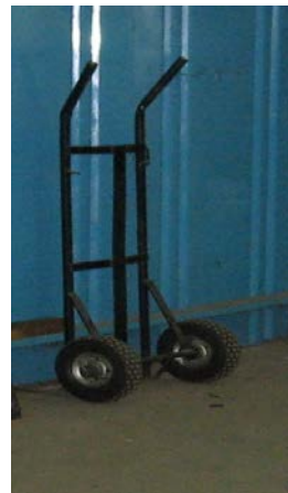
Figura N°12. Carrucha para traslado de arco de ventana.
