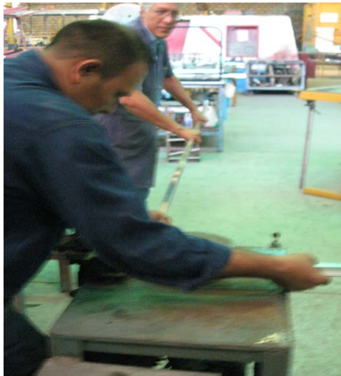
Figura N°17. Sacar perfil máquina dobladora
