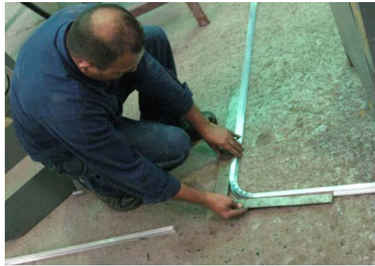
Figura N°10. Medida del arco de ventana Figura N°11. Ajuste arco de ventana.
