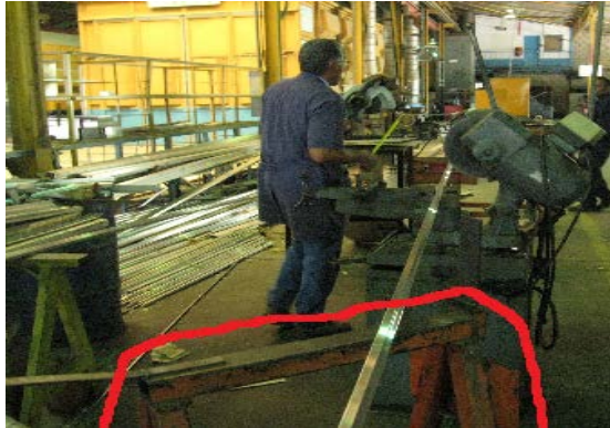
Figura N°6. Vigas improvisadas en el área de corte
