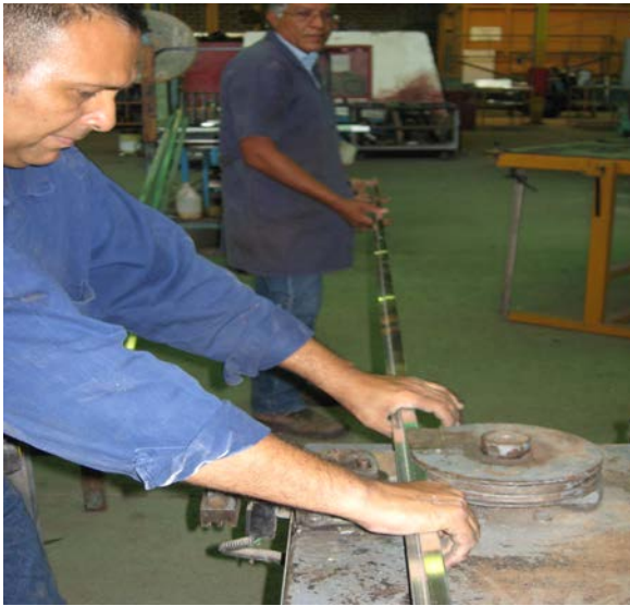
Figura N°7. Encaje de perfil en la troqueladora.
