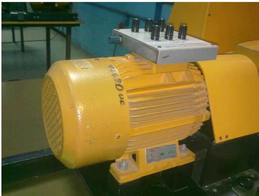
*Figura A.1. Motor trifásico de inducción jaula de ardilla.*
