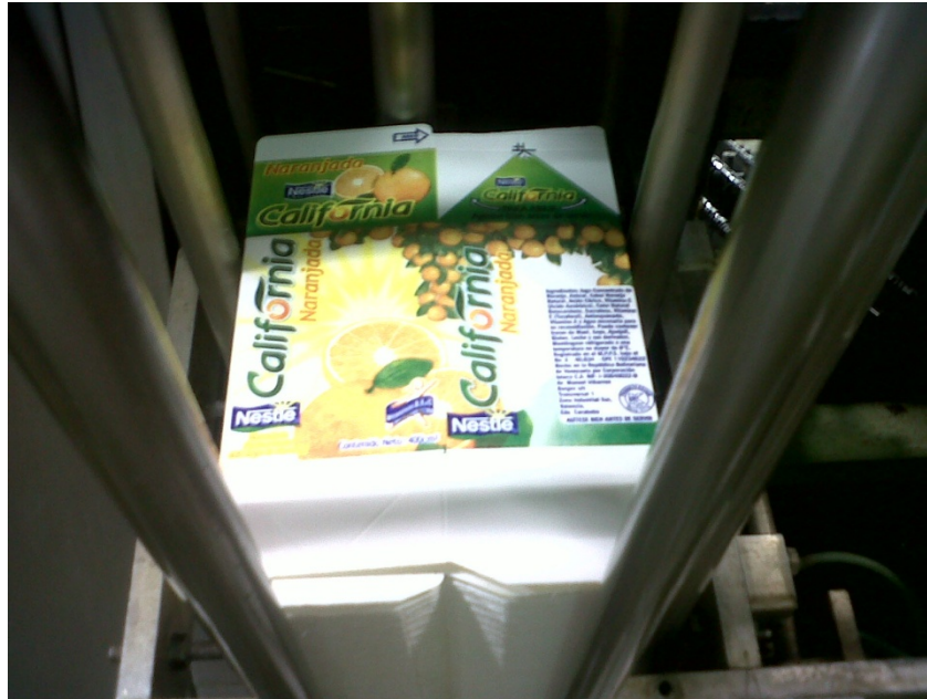
Figura 4.16. Foto de los empaques doblados antes de entrar a la máquina Cherry.
