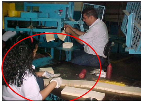
FIGURA N°10 Corte de fuelle.
