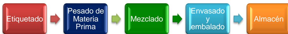
Inicialmente los envases son etiquetados; luego los ingredientes, previamente pesados, son vertidos manualmente o a través de bombas hacia un tanque de acero inoxidable y posteriormente son mezclados en el interior del tanque a través de un proceso de recirculación (la mezcla es absorbida por una bomba y vertida nuevamente de forma tangencial provocando un movimiento circular).
