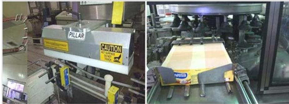
**Figura N° 16. Equipo sellador magnético de foil y etiquetadora**
