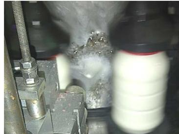
**Figura N° 26. Desperdicio generado en la adición de puntos de pega**
