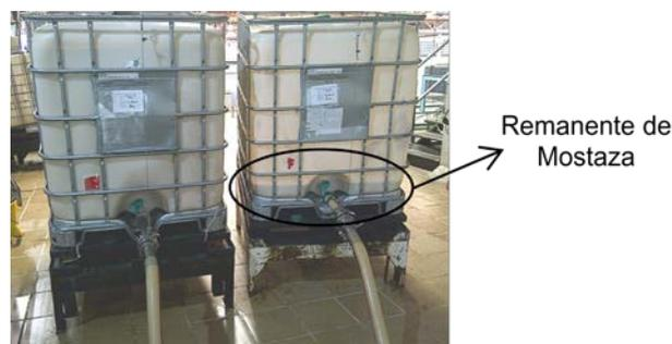
**Figura N° 28. Etapa del Trasiego de Mostaza a Tanque Pulmón**
