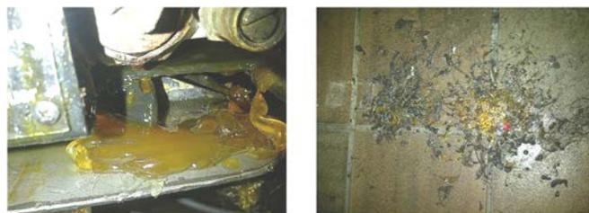
**Figura N° 24. Pega desbordada en la alimentación de equipo Nordson**
