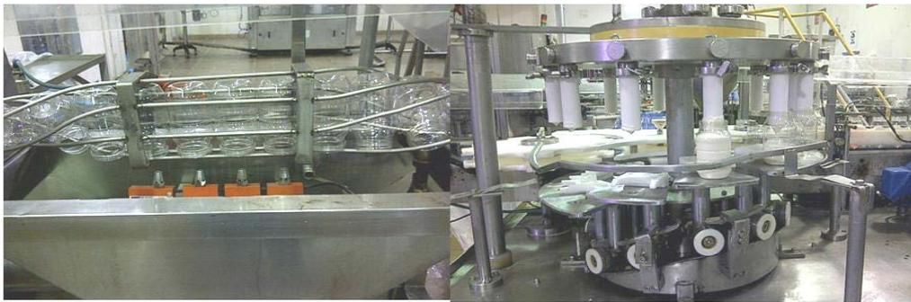
**Figura N° 14. Volteador soplador y llenado del producto**
