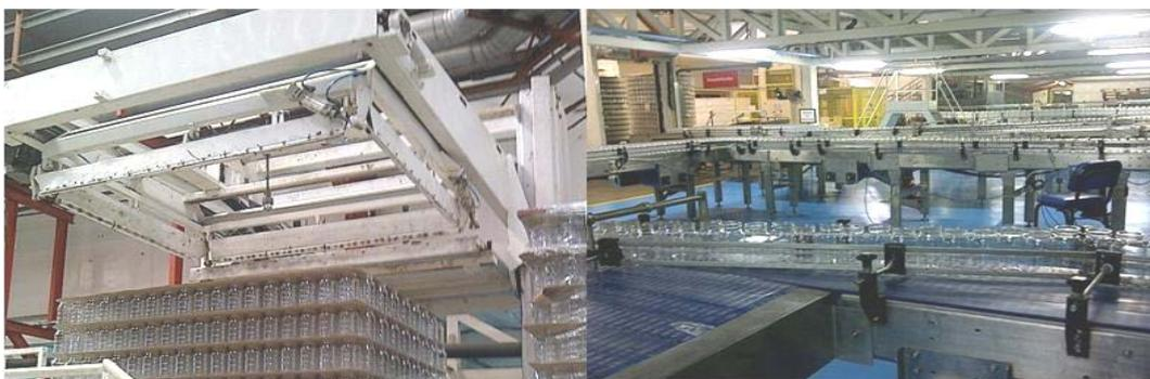
**Figura N° 13. Despaletizado de envases y líneas de emvasado**
