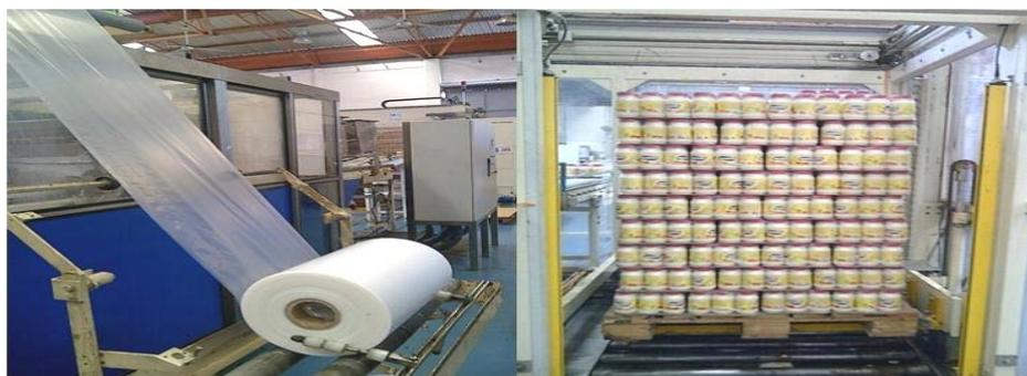
**Figura N° 17. Empacado con plástico termoencogible y paletizado automático.**
