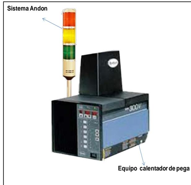
**Figura N° 39. Sistema ANDON instalado en equipo calentador Nordson**
