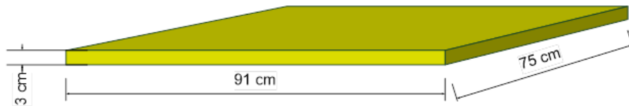
Figura VI-6. Placa de hierro para soporte de caja.
