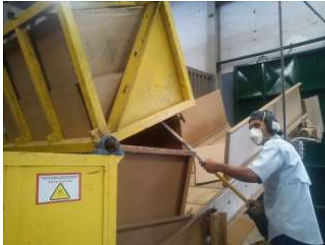
. Figura V-6. Movimientos innecesarios en el área de volteo N°1.
