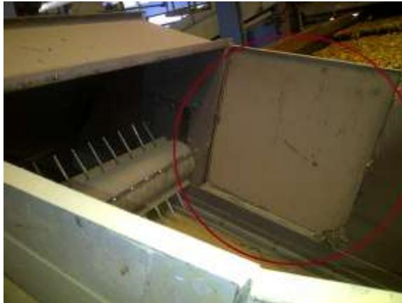
Figura V-4. Vena retenida en las paredes contenedoras de la faja sanitaria en el área de volteo N°2.
