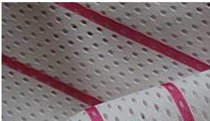
Figura VI-13. Modelo de malla de poliéster para la banda transportadora.
