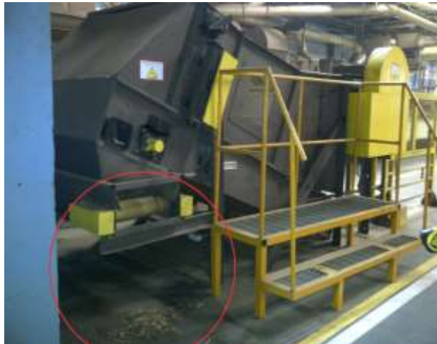
Figura V-3. Vena húmeda que cae al suelo en el área de volteo N° 2.
