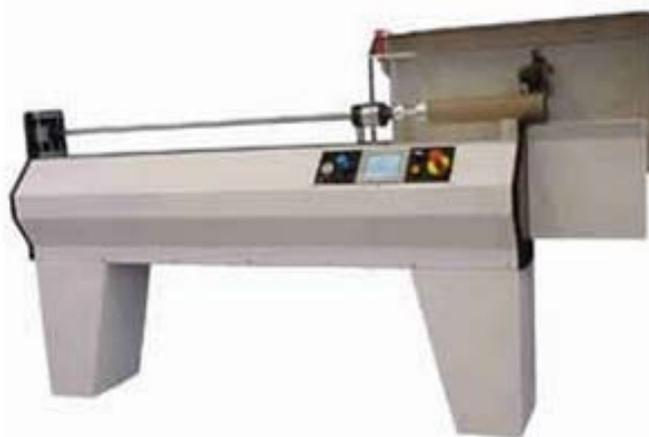
Para cortar tubos de cartón en dimensiones más pequeñas. La cortadora de tubos es totalmente automatizada y se puede programar cortes en diferentes tamaños en el mismo tubo. La máquina tiene una pantalla en color y el proceso se realiza mediante un PLC Siemens para ajustar automáticamente la distancia de corte de los cuchillos según el largo y la cantidad.
