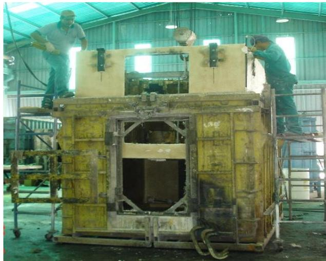
**Figura 4.6 Molde interno introducido en molde externo**
