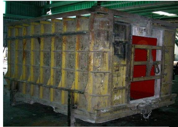
**Figura 4.4 Enfibrado molde interno (macho) Figura 4.5 Molde externo (hembra)**
