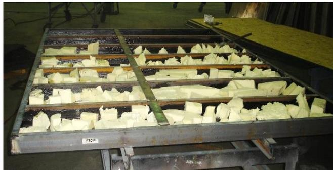
**Figura 4.3 Fabricación del piso**
