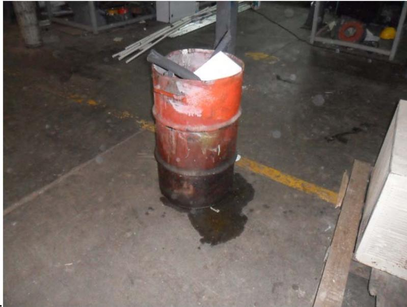
**Figura 5:** Disposición temporal de tambor de aceite en área de taller mecánico donde se aprecia derrame de lubricante.
