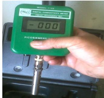
**Figura IV.6. Medición Conductividad Eléctrica**
