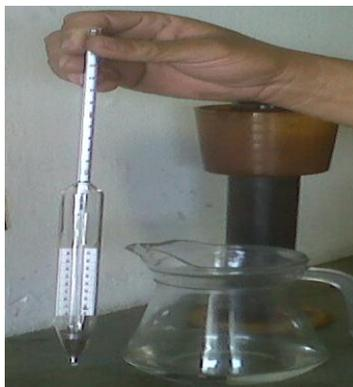
**Figura IV.5 Análisis de Temperatura y Densidad.**
