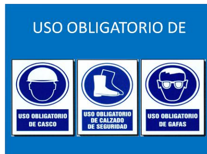
Figura. 15 Uso obligatorio de equipos de seguridad.
