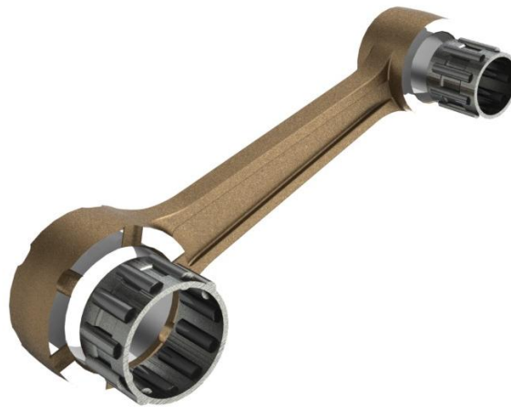
Figura 4.15 Representación de los rodamientos de la biela
