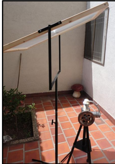
Figura 4.37 Calentamiento del prototipo mediante el lente Fresnel
