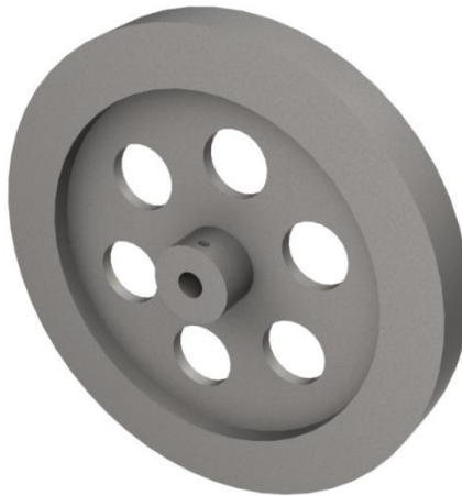
Figura 4.11 Volante de inercia optimizado
