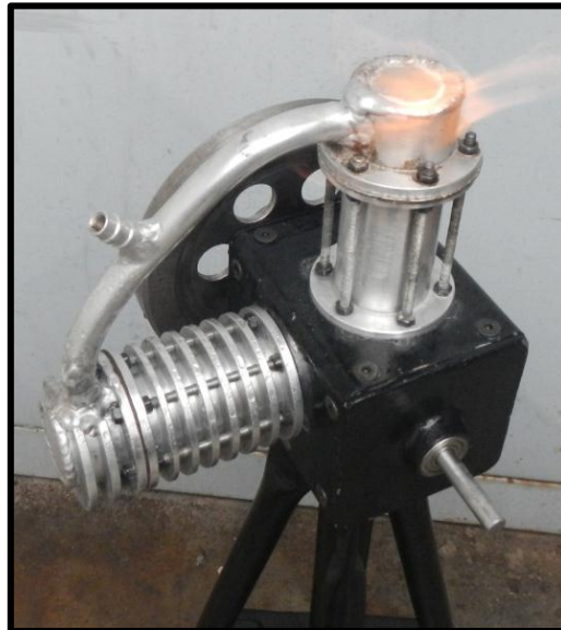
Figura 4.34 Motor Stirling finalizado
