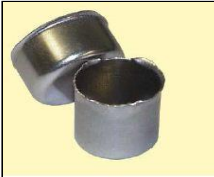
Figura 2.11 Formación de un labio en el borde de una pieza embutida. (Fuente: ASCAMM).
