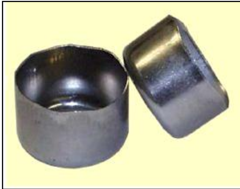
Figura 2.10 Pieza con sinuosidades en el borde superior de embutición (Fuente: ASCAMM).
