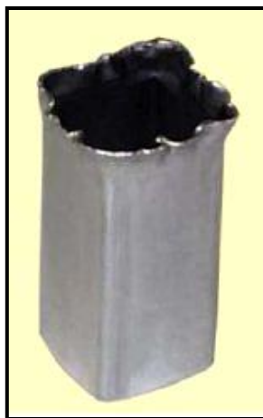
Figura 2.9 Pieza con flecos alrededor de los bordes superiores (Fuente: ASCAMM).
