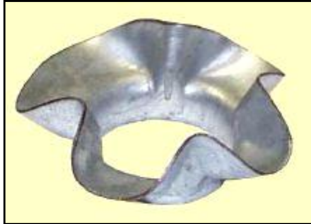
Figura 2.8 Pieza embutida desgarrada en el fondo. (Fuente: ASCAMM).
