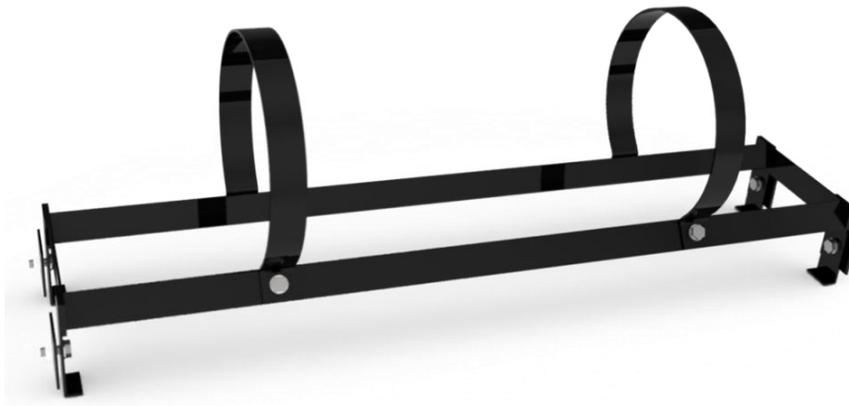
**Figura 3.5.** Representación en CAD de la estructura de sujeción “B”.
