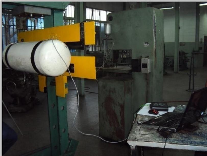
**Figura 3.21.** Montaje del transductor Análogo-Digital MCC USB-2404-UI.
