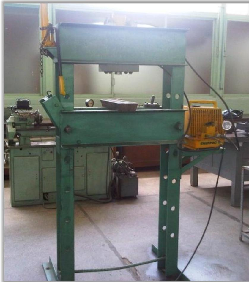
**Figura 3.17.** Prensa hidráulica utilizada para realizar el ensayo físico.
