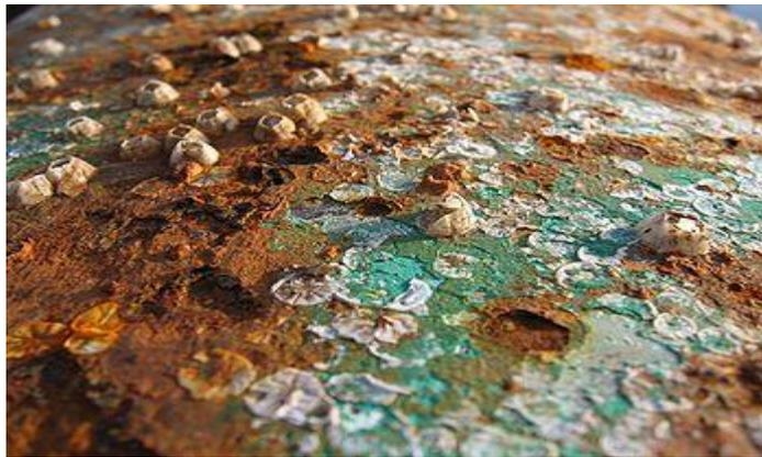
**Figura 2.10.** Corrosión húmeda
