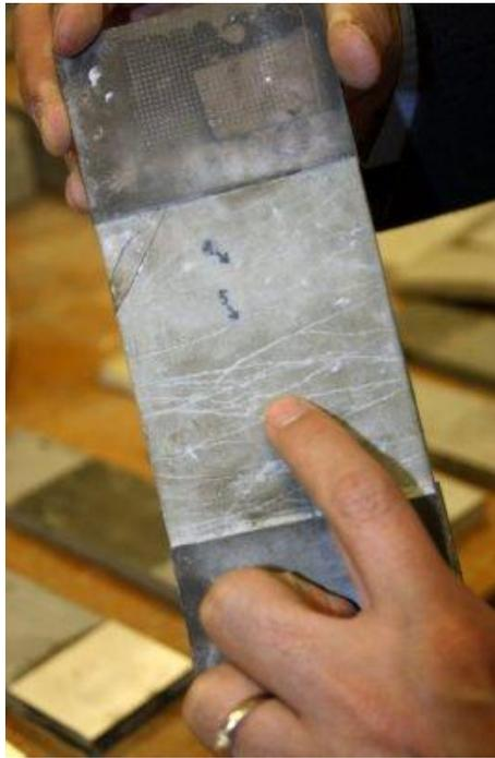
**Figura 2.14.** Corrosión en grietas.
