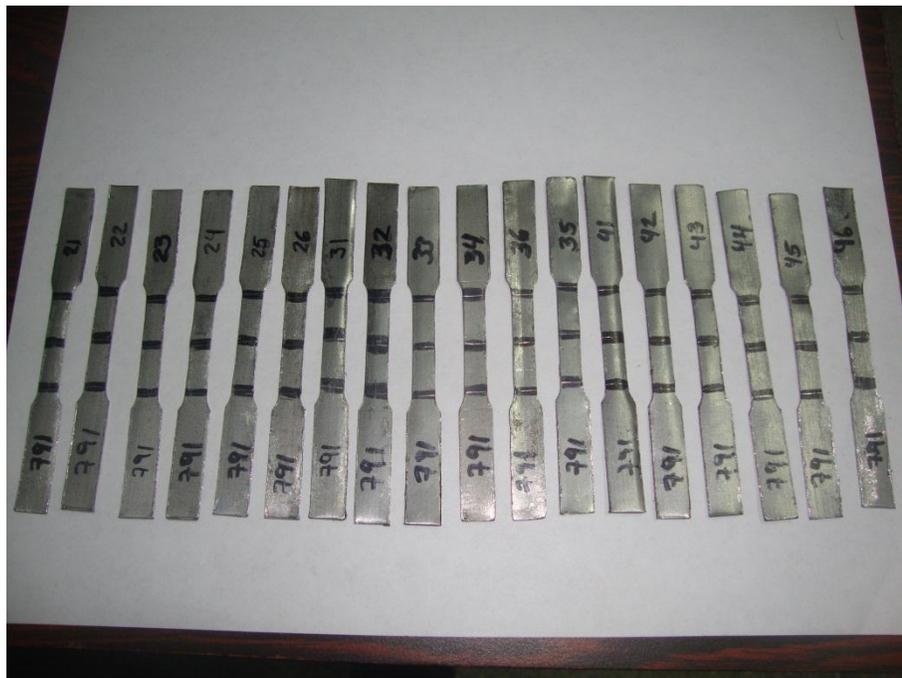
Figura 3.7: Probetas de tracción obtenidas de los recipientes.
