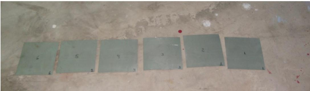
Figura 3.12: Probetas para el ensayo de embutibilidad.
