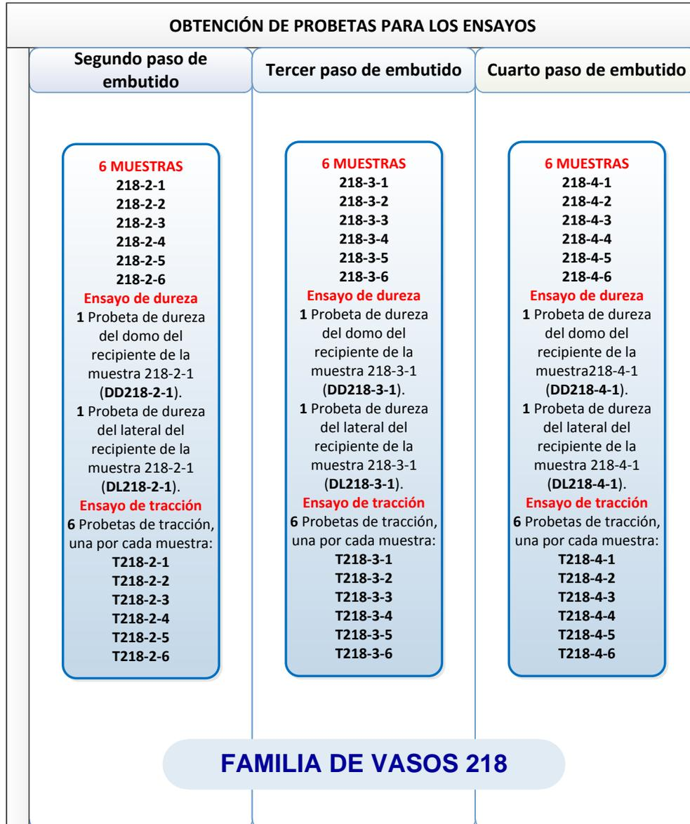
Figura 4.3: Identificación de probetas obtenidas de la familia 218.
