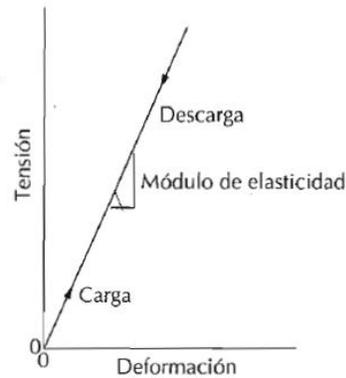
Figura 2.2: Diagrama tensión deformación elástica.
