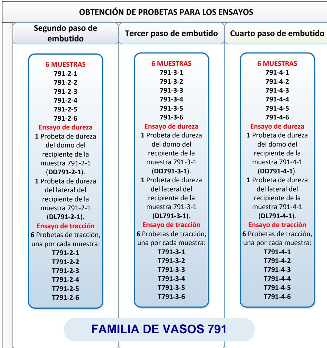
Figura 4.2: Identificación de probetas obtenidas de la familia 791.
