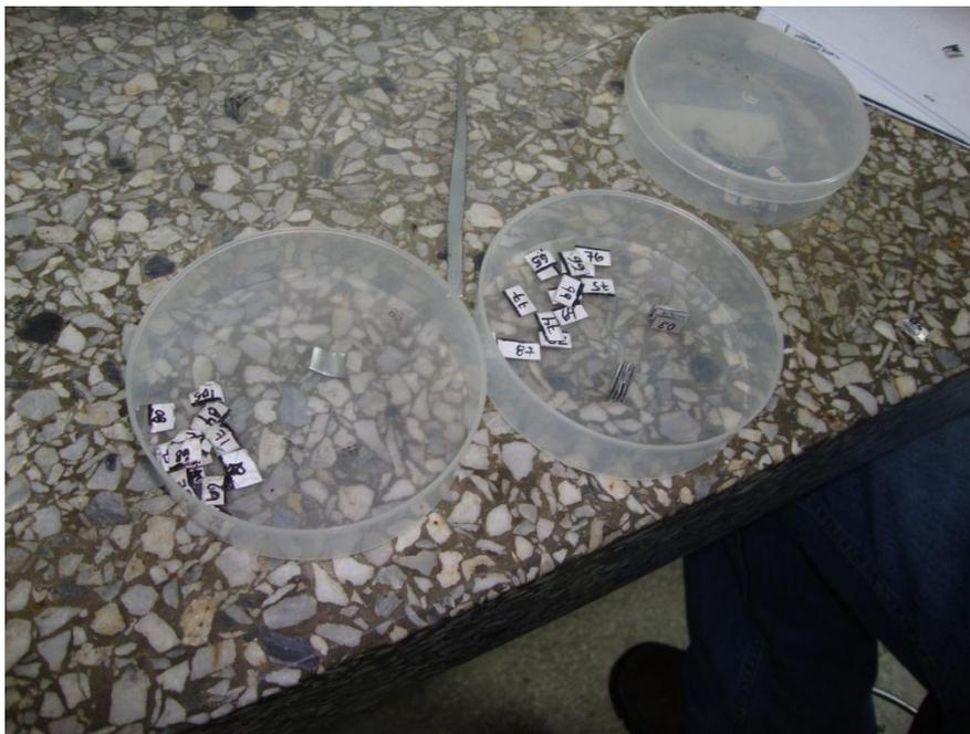
Figura 3.9: Probetas para el ensayo de dureza.
