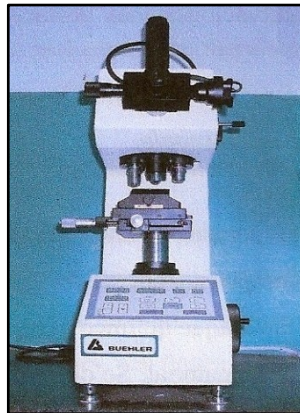
Figura 3.13. Máquina Buehler de ensayo de microdureza. vickers (Fuente propia).
