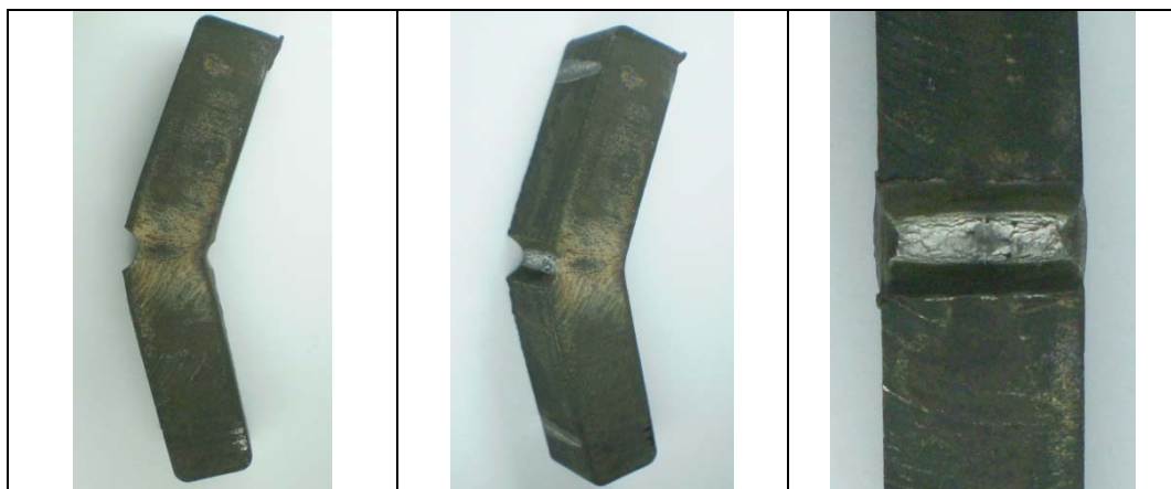
Figura 4.27 Probeta Charpy condición Temple 1050°C+Revenido 400°C a 10min.
