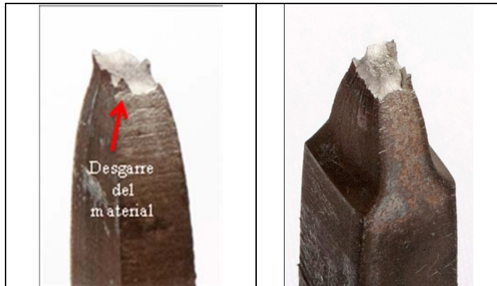
Figura 4.17 Probeta Tracción condición Temple 950°C+Revenido 400°C a 10min.
