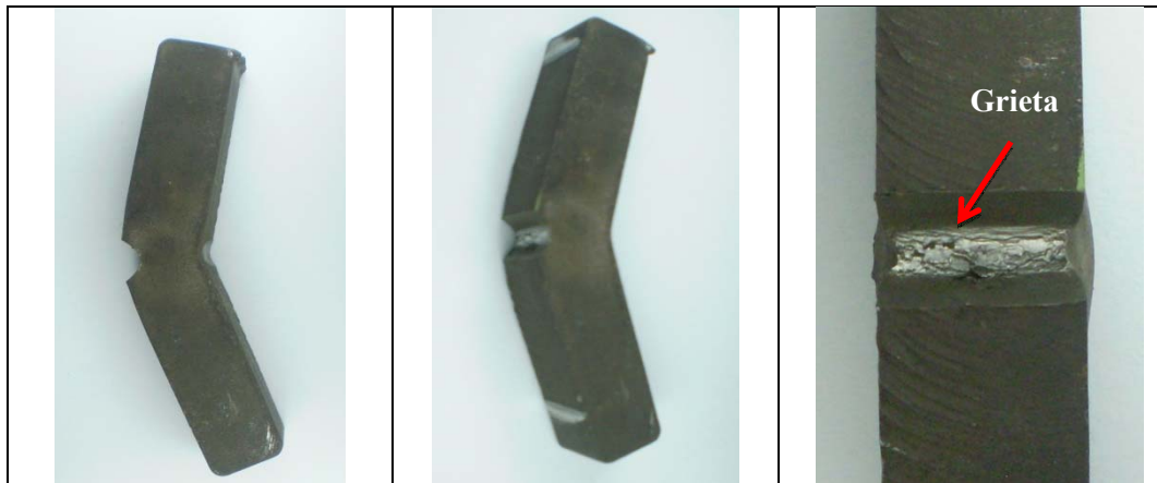
Figura 4.25 Probeta Charpy condición Temple 950°C+Revenido 400°C a 12min.
