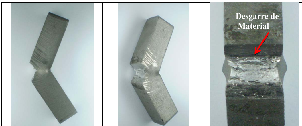
Figura 4.23 Probeta Charpy en la condición original.
