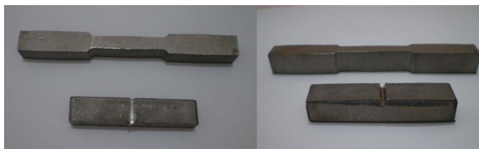
Figura 3.4 probetas de Tracción y Charpy utilizadas.
