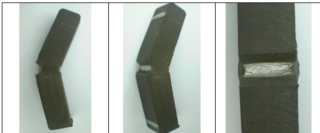
Figura 4.26 Probeta Charpy condición Temple 950°C+Revenido 400°C a 15min.
