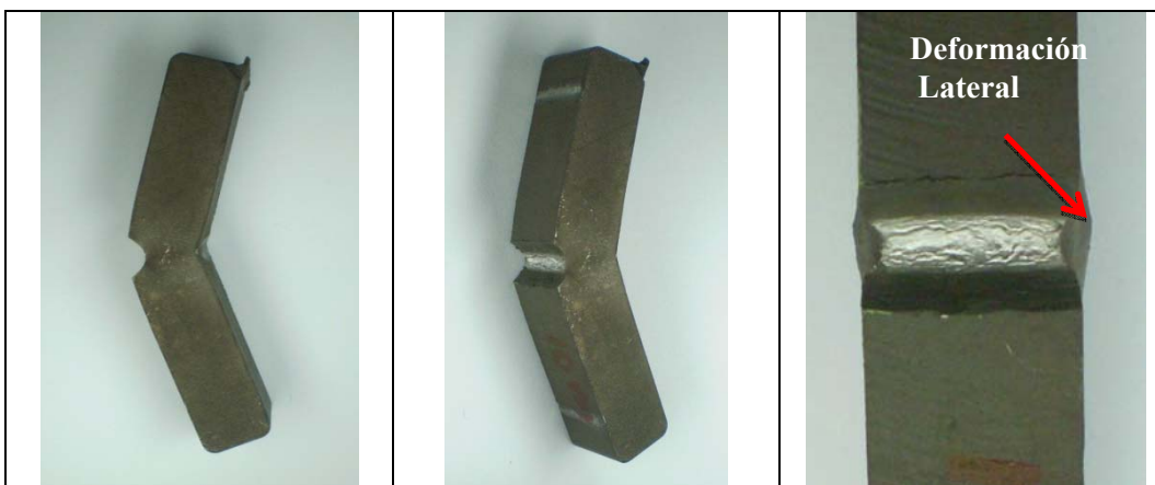
Figura 4.24 Probeta Charpy condición Temple 950°C+Revenido 400°C a 10min.
