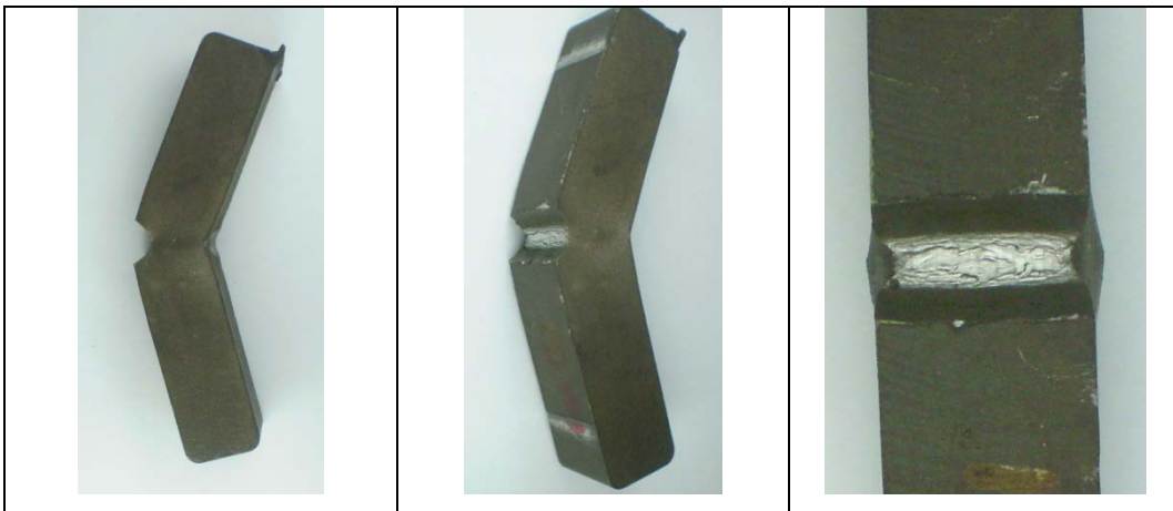
Figura 4.29 Probeta Charpy condición Temple 1050°C+Revenido 400°C a 15min.
