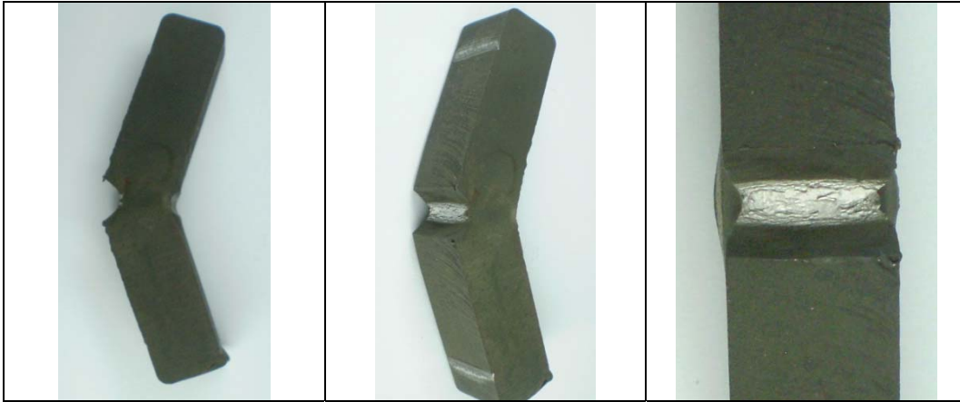
Figura 4.28 Probeta Charpy condición Temple 1050°C+Revenido 400°C a 12min.
