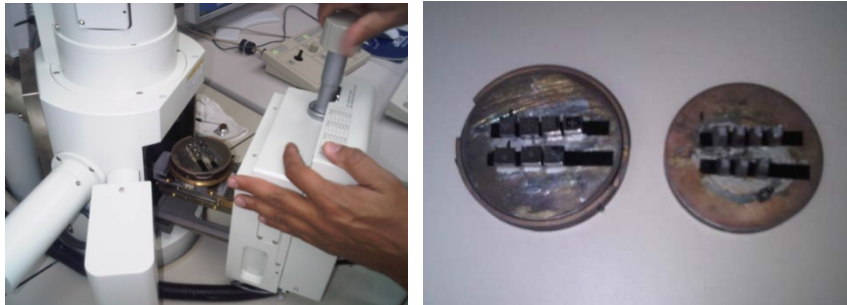
Figura 4.31 Preparación y colocación de las muestras en el microscopio electrónico de barrido MEB.
