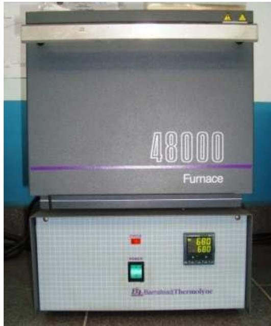
**Figura 3.5** Horno para recocido a 680 °C
