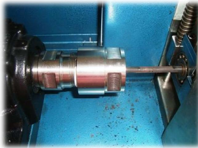
**Figura 3.9** Probeta ajustada en la máquina de fatiga
