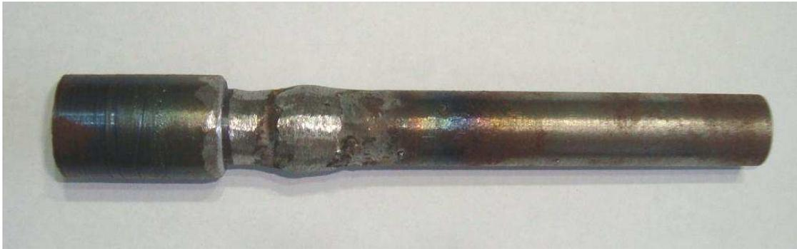
**Figura 3.2.** Foto de la probeta soldada antes del mecanizado final
