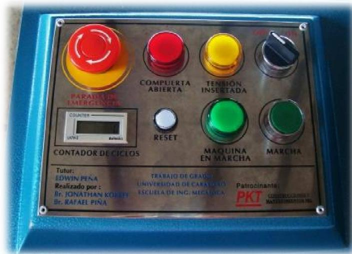
**Figura 3.11** Tablero de control de la máquina de fatiga
