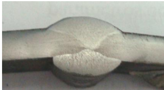
Figura 4.1. Probeta 1, A36- A36, 90 Amp. y 20 Volt.
