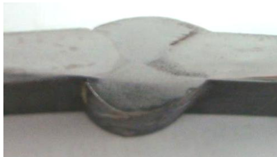
Figura 4.2. Probeta 8, A131 – A36, 93 Amp. y 22 Volt.
