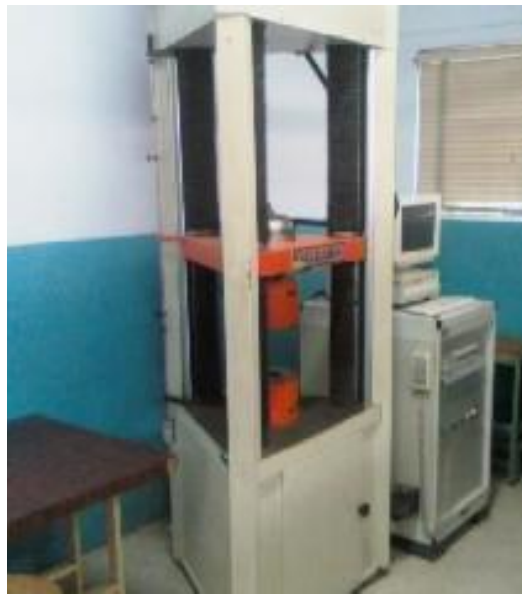
Figura 2.11. GALDABINI para realización de ensayo de doblado Fuente: Laboratorio de materiales y procesos de fabricación, UC.
