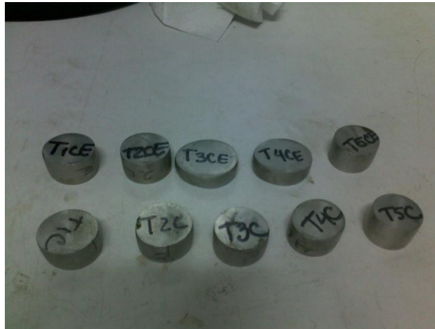
Figura 4.36. Imagen de las probetas de compresión cilíndrica cortadas transversalmente.
